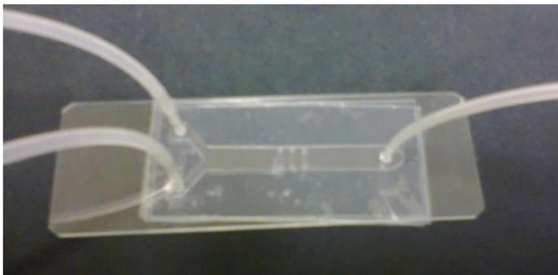
**Figura 20:** Dispositivo microfluídico do tipo Vidro-vidro com selagem reversível por aderência do PDMS laminado.
