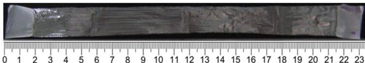
Figura 28: Filme de policaprolactona submetido ao teste de resistência mecânica.
