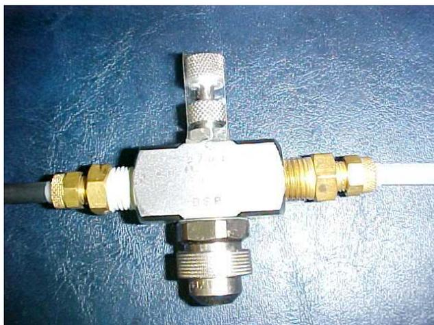
Figura 15: Câmara de atomização e bico de injeção utilizados na produção de microesferas de quitosana.
