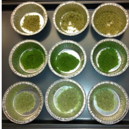
A perda de massa do material é equivalente ao seu conteúdo de umidade, que é calculado conforme Eq. 3.1 e Eq. 3.2.
