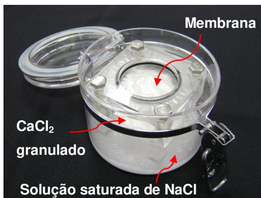
Figura 12: Aparato experimental utilizado no ensaio de determinação da permeabilidade e taxa de transmissão de vapor d'água das membranas estudadas.
