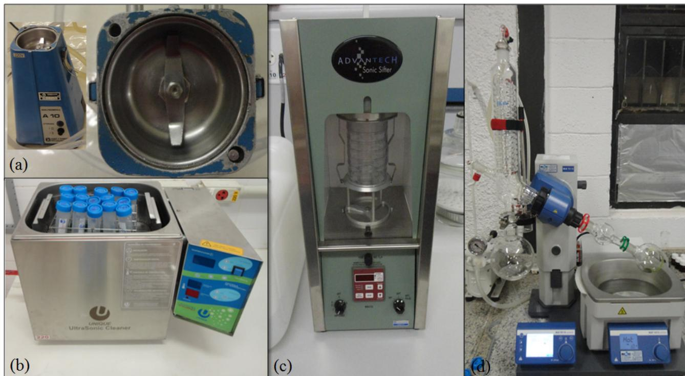
(a) Moinho, (b) Banho ultrassônico, (c) Separador sonic sifter, (d) Evaporador rotativo. Fonte: Silva (2013k)
