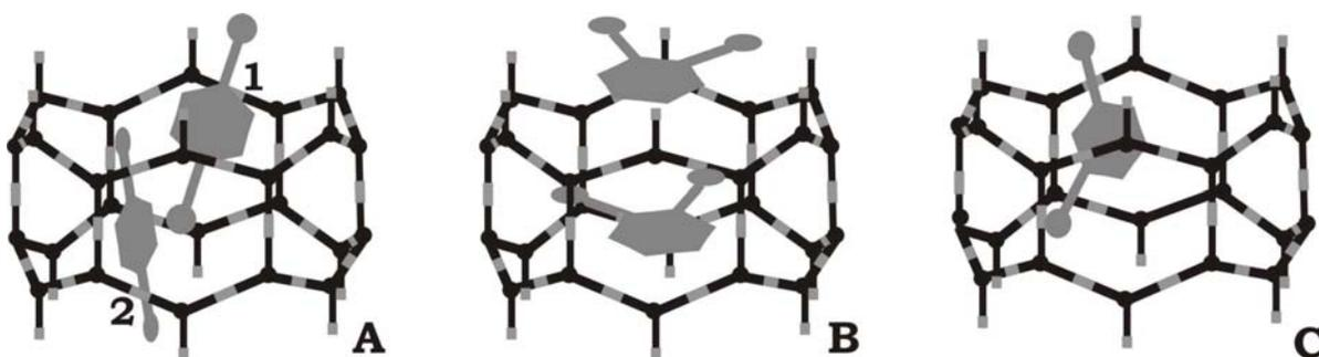
**Figura 2.7** Representação da configuração das moléculas de xilenos no poro de  $\text{AlPO}_4\text{-5}$  a  $30^\circ\text{C}$ . (A) - Moléculas de p-xileno inclinadas podem posicionar-se nas janelas (1) ou nas grades (2). (B) - Moléculas de o-xileno sempre dispostas face-a-face nas grades. (C) – Moléculas de m-xileno posicionadas nas janelas.
