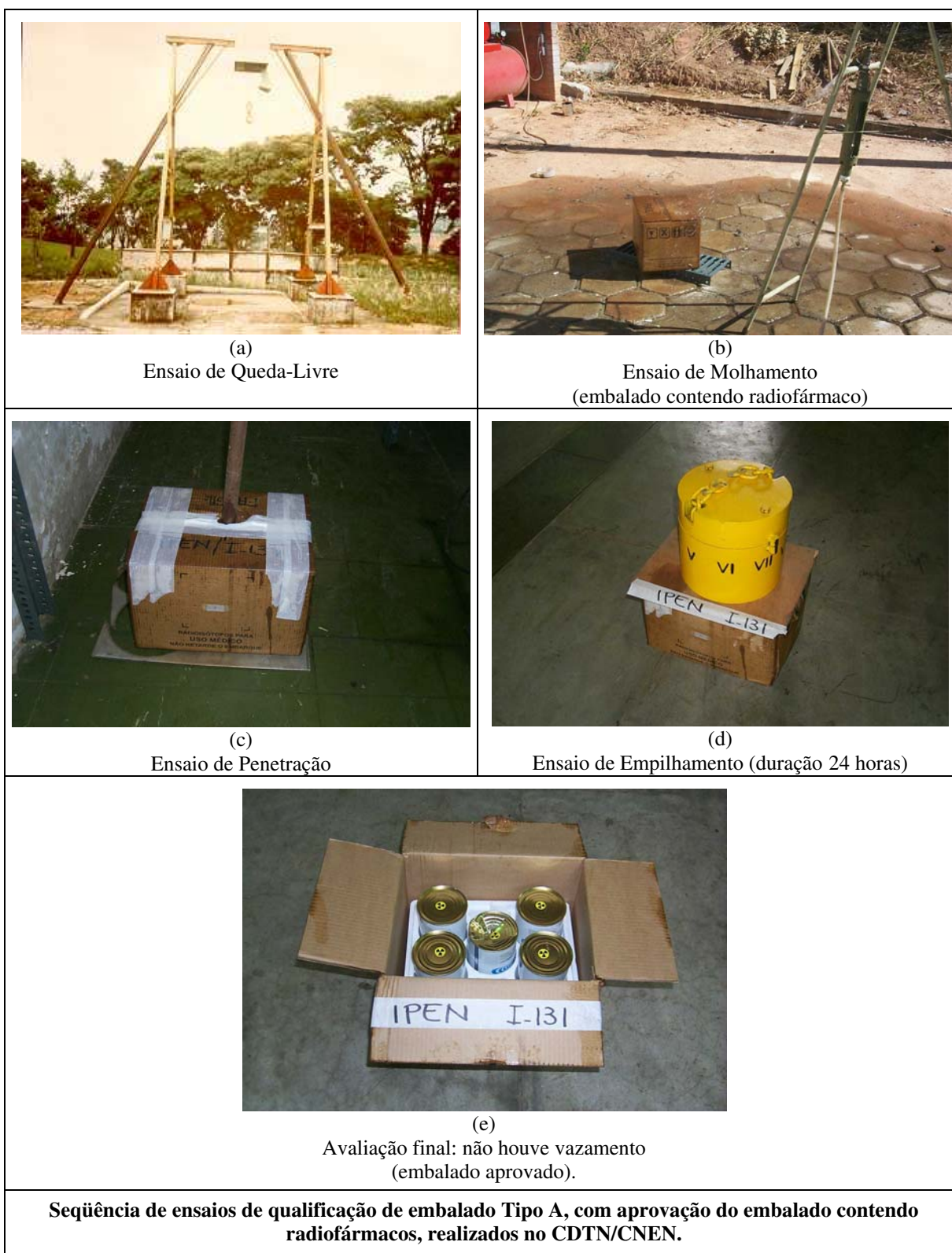
Figura 3.53 - Ensaios de qualificação de embalado Tipo A.
