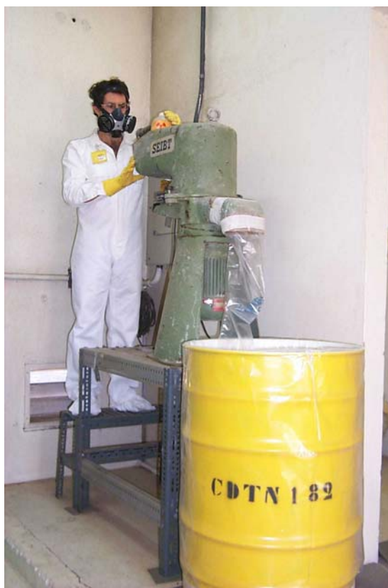
Figura 3.38 - Moinho para descaracterizar frascos plásticos do CDTN.
