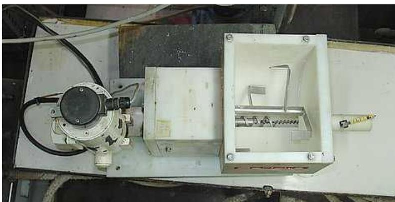
Figura 4.18 Dosador de resinas de troca-iônica exauridas - detalhe
