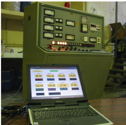
Figura 4.20 Tela do microcomputador indicando as temperaturas do processo
