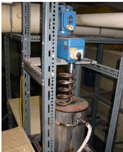
Figura 4.13 Tanque de betume com misturador-agitador
