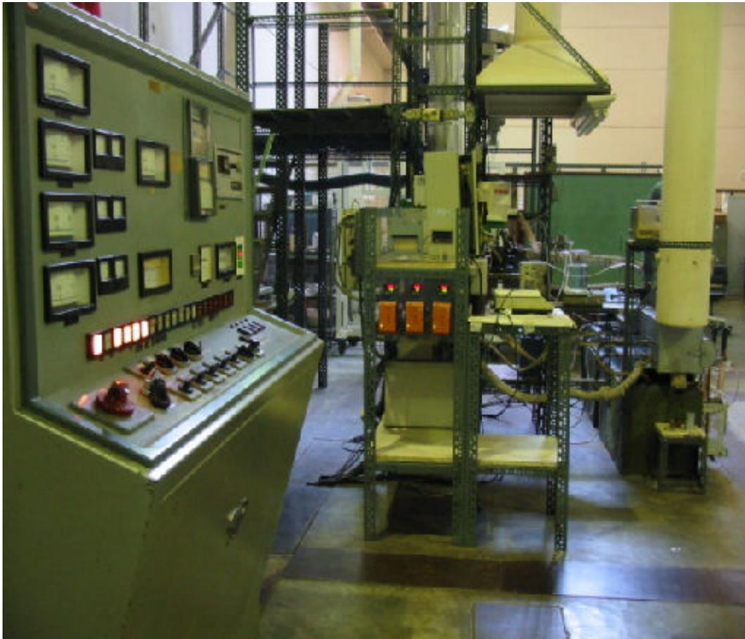
Figura 4.14 Painel de controle do sistema de tratamento de rejeitos
