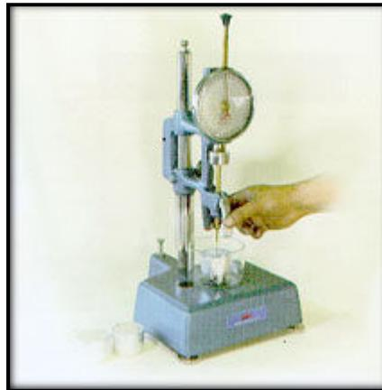
Figura 4.22 Aparelho para determinação da penetração
