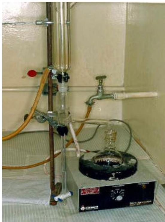
Figura 4.26 Montagem para determinação do teor de água
