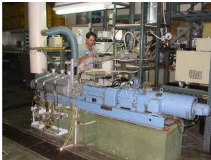
Figura 4.5 Extrusor-evaporador piloto do CDTN
