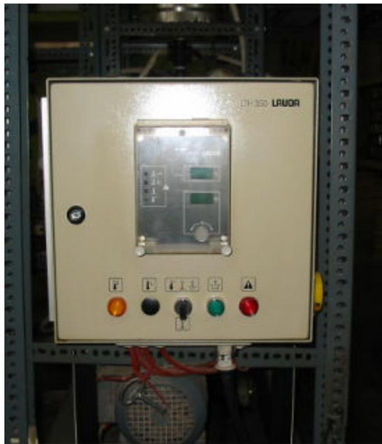
Figura 4.10 Banho termostático para tanque de betume - vista frontal
