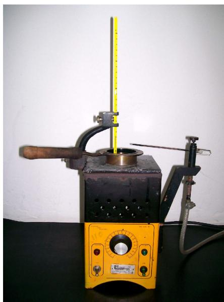
Figura 4.24 Aparelho para determinação do Ponto de Fulgor
