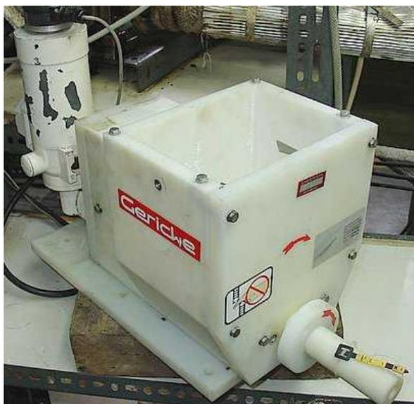
Figura 4.17 Dosador de resinas de troca-iônica exauridas
