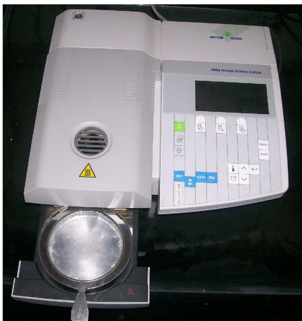
Figura 4.21 Analisador de umidade de halogênio
