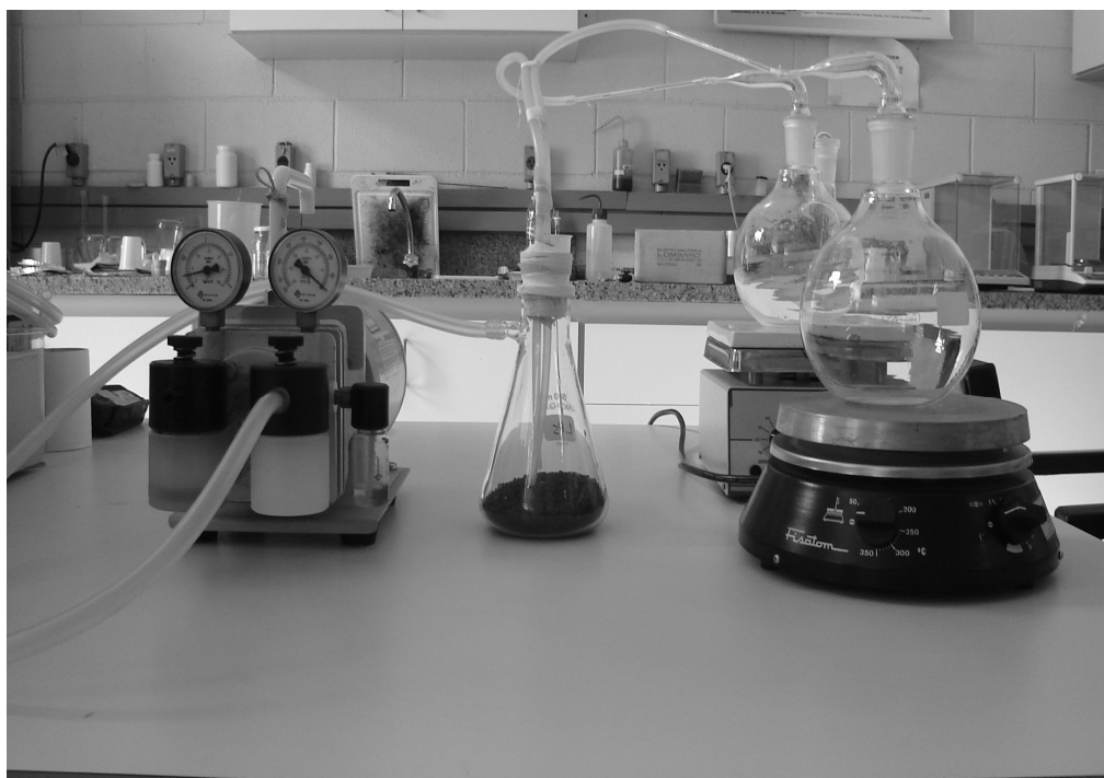
Figura 11. Sistema de extração e coleta dos voláteis de abacaxi montado no Laboratório de Processos Sólido-Fluido
