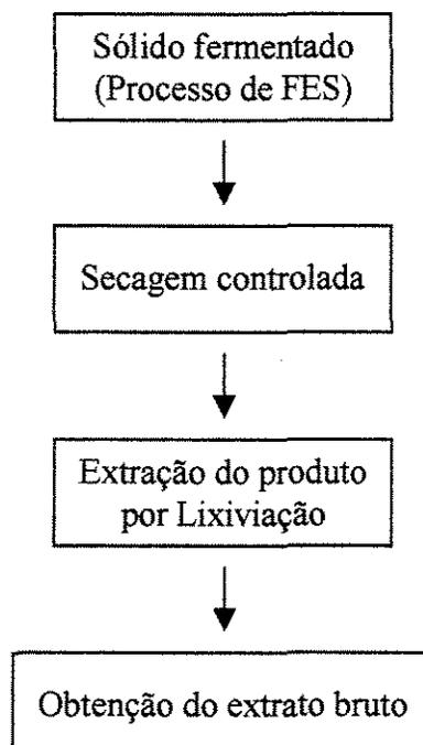
Figura 3.1. Esquema da seqüência de operações do processo de RPB de produtos intra e extracelulares de processos de FES.
