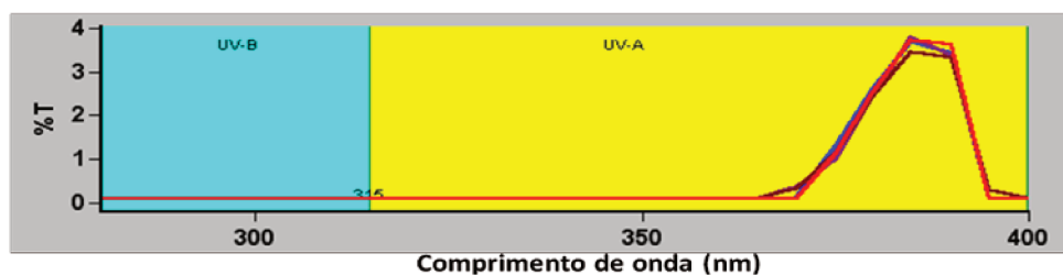
Figura 65. Curva da transmitância em função do comprimento de onda para o tecido de malha de poliamida 6.6, LFA de 900 cm/volta, sem tensão
