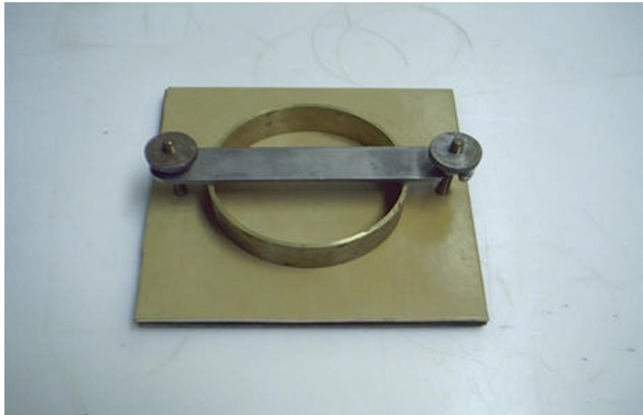
**Figura 8:** Foto ilustrativa da Cuba Metálica, utilizada em análise de absorção de água método Cobb Tester
