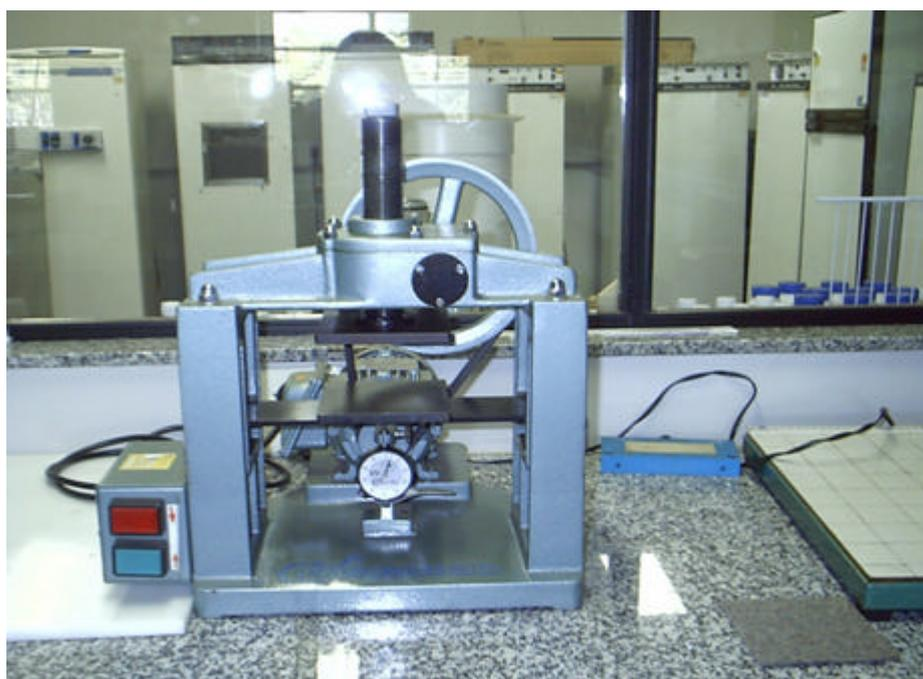
**Figura 5:** Foto ilustrativa do equipamento (Prensa Crush-Tester) utilizada em análise de resistência ao esmagamento.
