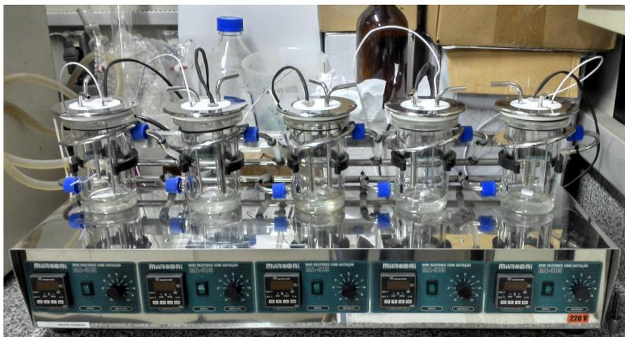
**Figura 3. 29.** Bateria de reatores
