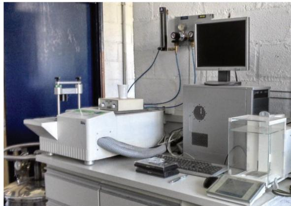
**Figura 3.32.** Equipamento modelo 2920 Modulated DSC da TA instruments
