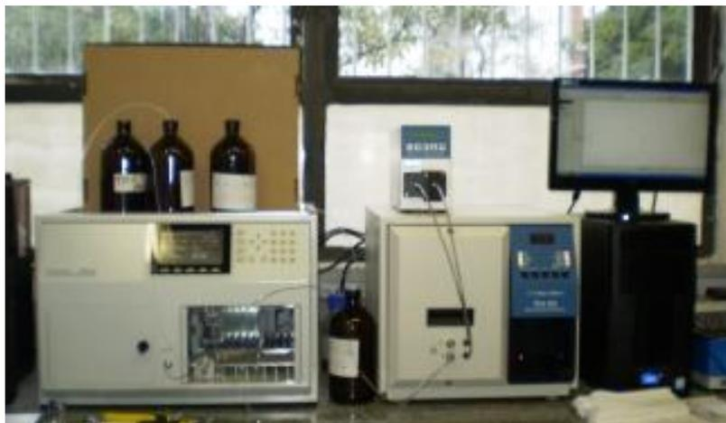
**Figura 3.30.** Cromatógrafo CPG Viscotek TDA 302
