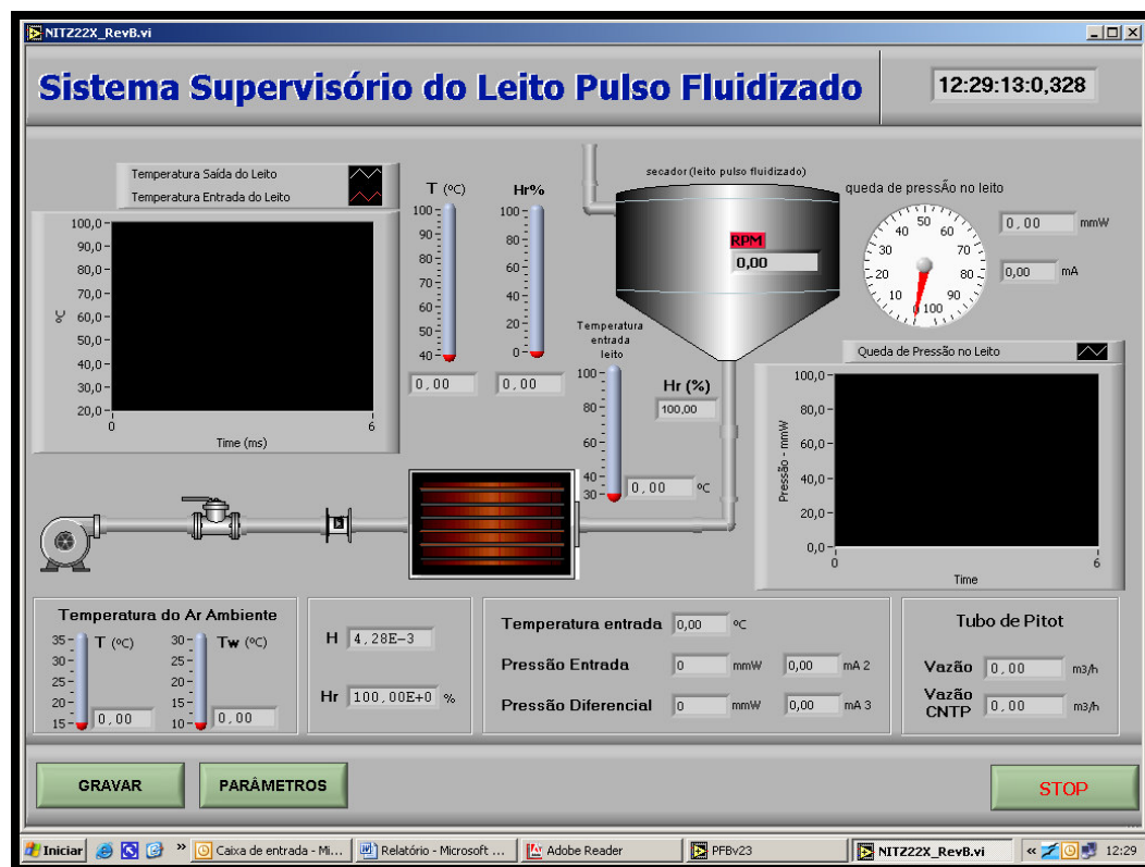
Figura 3.17 – Tela gerada pelo aplicativo de supervisão e aquisição de dados da operação.
