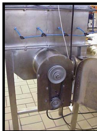
Figura 3.9 – Polias e correia, partes do sistema de pulsação da corrente gasosa.
