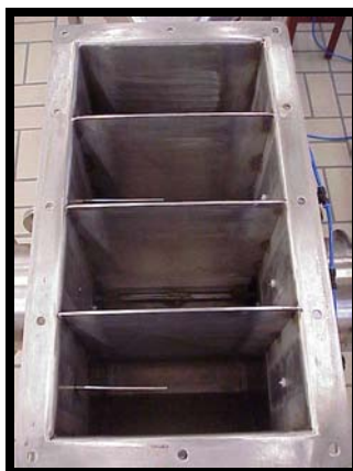
Figura 3.7 – Câmara de distribuição de ar com quatro seções.
