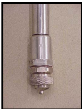
Figura 3.19 – Bico de pulverização – duplo fluido, mistura interna.
