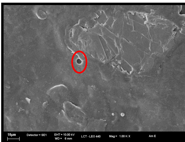
Figura 4.74 – Poro de grânulo revestido em destaque, ensaio V+f+d+t+, ampliação de 1000 vezes
