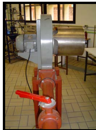
Figura 3.4 – Válvula borboleta à jusante do ventilador.
