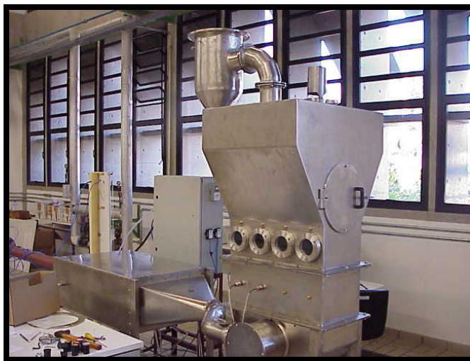
Figura 3.1 – Vista do leito pulso-fluidizado.
