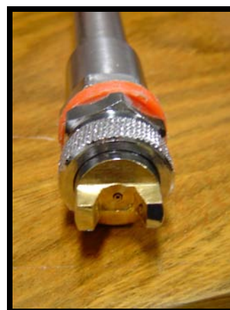
Figura 3.20 – Bico de pulverização – duplo fluido, mistura externa.
