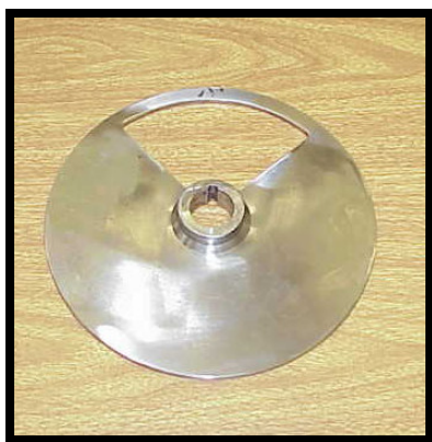
Figura 3.8 – Disco rotativo, peça responsável pelo redirecionamento da corrente gasosa.
