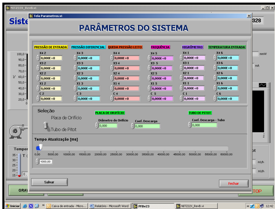
Figura 3.18 – Tela para colocação de parâmetros de calibração no sistema supervisório.
