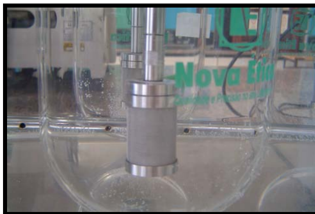
Figura 3.27 – Vista da cuba e do cesto (aparato 1) empregado no teste de dissolução.
