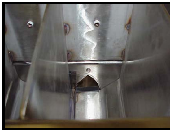
Figura 3.11 – Vista interna da câmara de distribuição do ar. No centro da figura é visível a abertura do disco rotativo.
