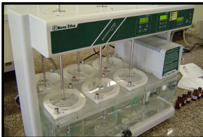
Figura 3.28 – Fotografia do dissolutor de 6 cubas da Novaética.
