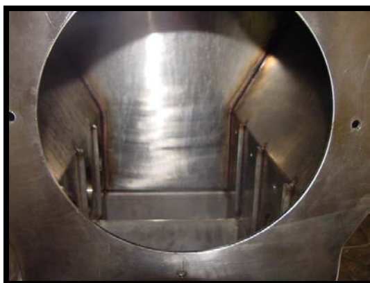
Figura 3.26 – Ampla abertura frontal para colocação do material 12 e retirada de amostra.
