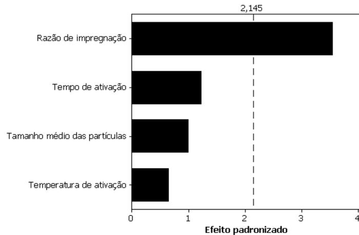
FIGURA 21. Diagrama de Pareto dos efeitos estimados para a variável resposta Rendimento da Ativação.
