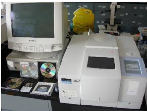
Figura 18. Espectrômetro One FT-IR da Perkin Elmer
