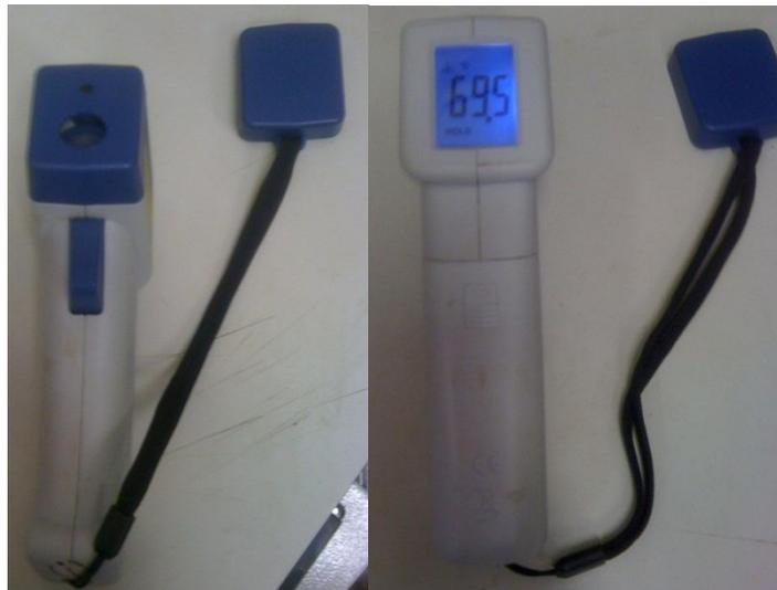
**Figura 27. Pirômetro usado para o monitoramento da temperatura dentro do microreator.**
