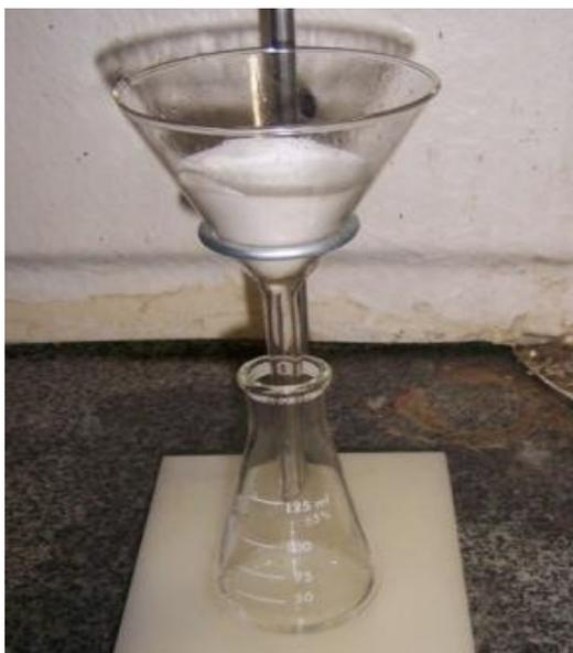
**Figura 16. Filtração da Resina**
