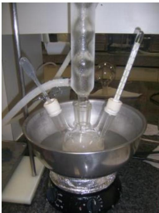
**Figura 15. Montagem para síntese da resina**
