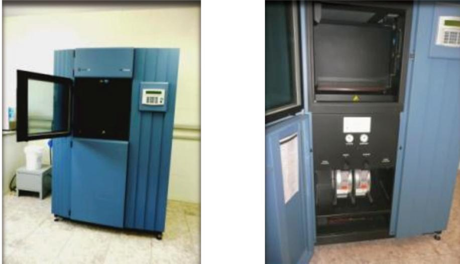
**Figura 36. Máquina FDM da Stratasys Inc [62].**
