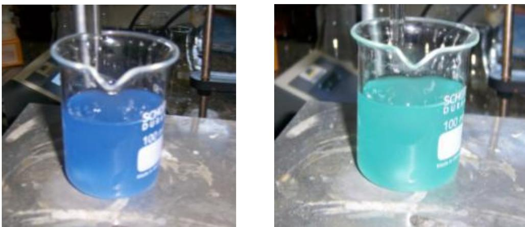
**Figura 19. Cambio de cor no ponto de equivalência da titulação.**
