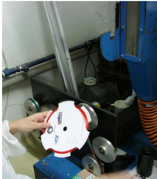
**Figura 3.7:** Embobinamento da FOP extrusada.
