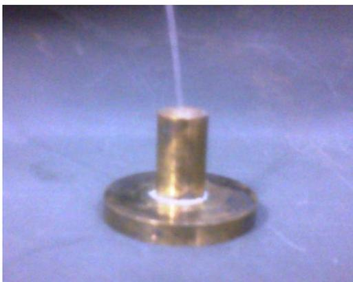
**Figura 3.10:** Ferrolho com a FOP inserida
