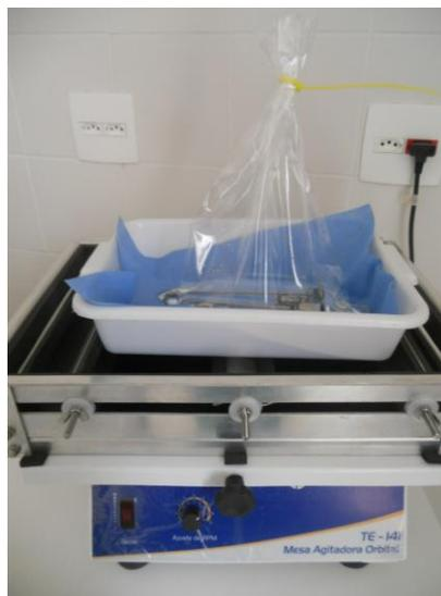
**Figura 11:** Agitação do trocarte em mesa agitadora orbital. Campinas, 2012.
