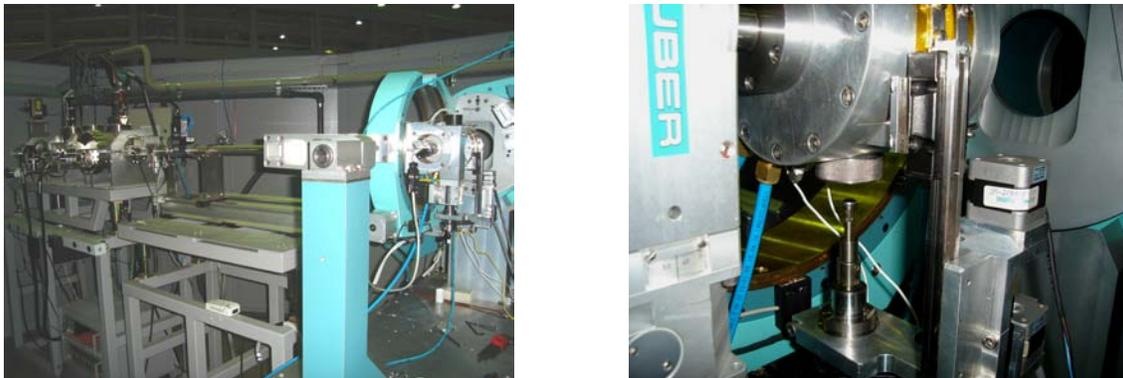
Figura 3.9. Linha de difração de raios-X de alta resolução usando luz síncrotron com câmara de aquecimento a vácuo (equipamento do LNLS).
