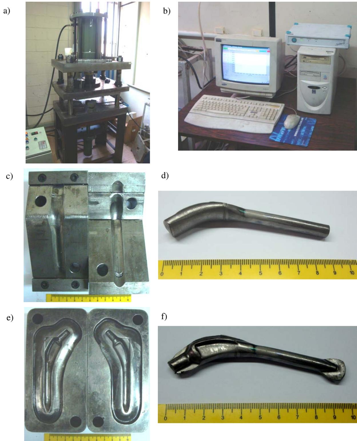
Figura 3.6. (a) Prensa hidráulica com capacidade de 100 t, (b) sistema de aquisição de dados de carga, (c) matriz de dobramento, (d) pré-forma dobrada, (e) matriz de forjamento e (f) haste da prótese total de quadril com rebarbas do processo de forjamento.
