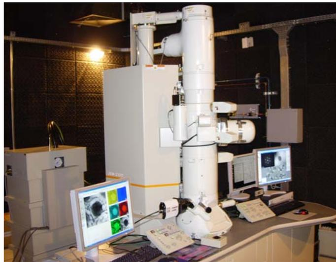
Figura 3.12. Microscópio eletrônico de transmissão (TEM) Jeol JEM 2100 com canhão de 200 kV de  $\text{LaB}_6$  com STEM e EDS integrados.
