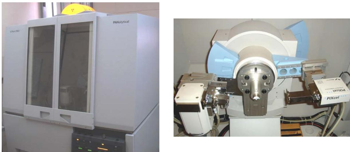
Figura 3.11. Difratômetro marca Panalytical, modelo X'pert PRO com detector PIXcel ultra rápido.
