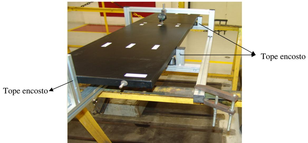
Figura 4.7 – Fotografia do dispositivo com três pontos de encosto
