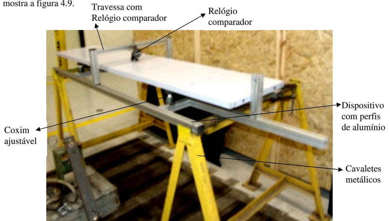
Figura 4.6 – Fotografia do dispositivo para medição da planeza.
