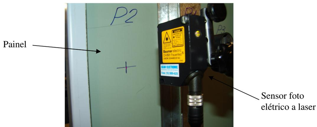
Figura 4.3 – Fotografia do Sensor foto elétrico – Posicionado no ponto P2 do conjunto painel colado e rebitado.
