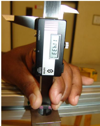
Figura 5.11 – Medição do deslocamento máximo permanente no conjunto painel soldado com o paquímetro
