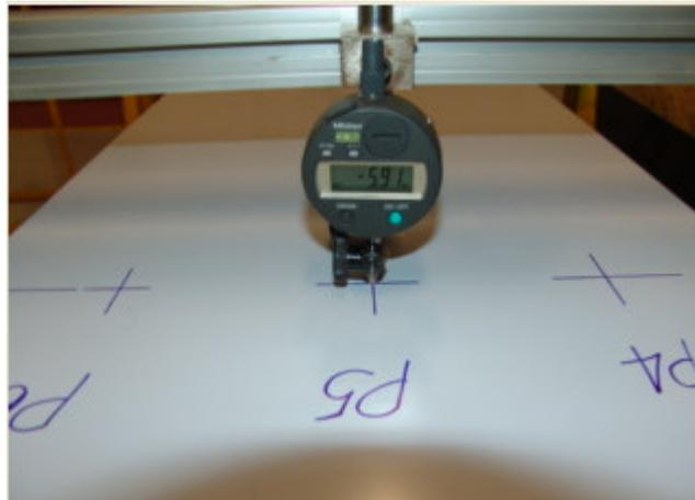
Figura 4.10 – Fotografia da medição da planeza do ponto P5 no conj. painel colado.
