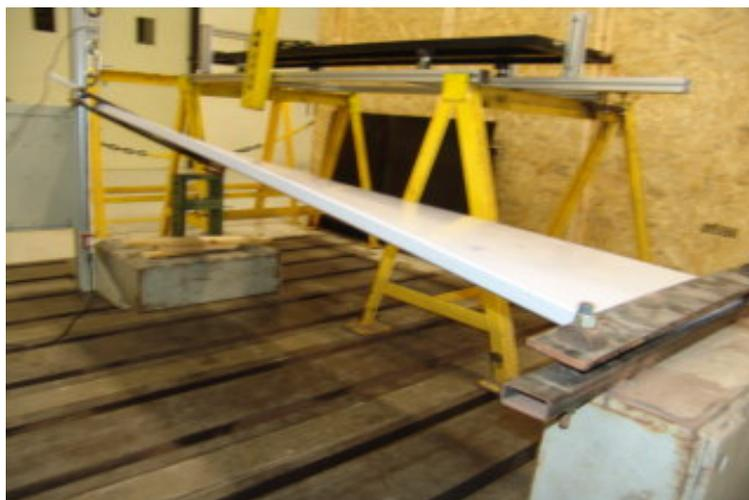
Figura 4.15 – Fotografia do conj. painel colado durante ensaio de torção.
