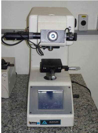
Figura 3.7. Equipamento empregado nas medidas de microdureza Vickers.
