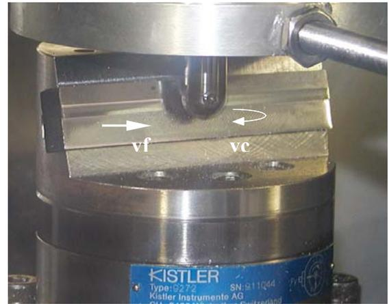
Figura 3.7 – Direções de “vc” e “vf”
