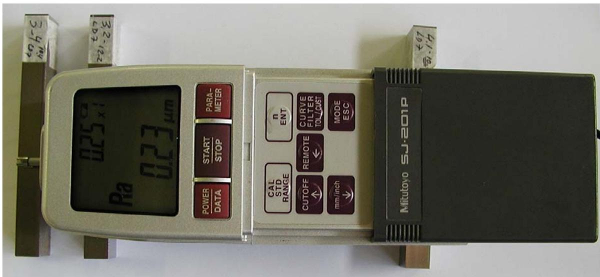
Figura 3.10 – Ilustração do rugosímetro e da medição da rugosidade
