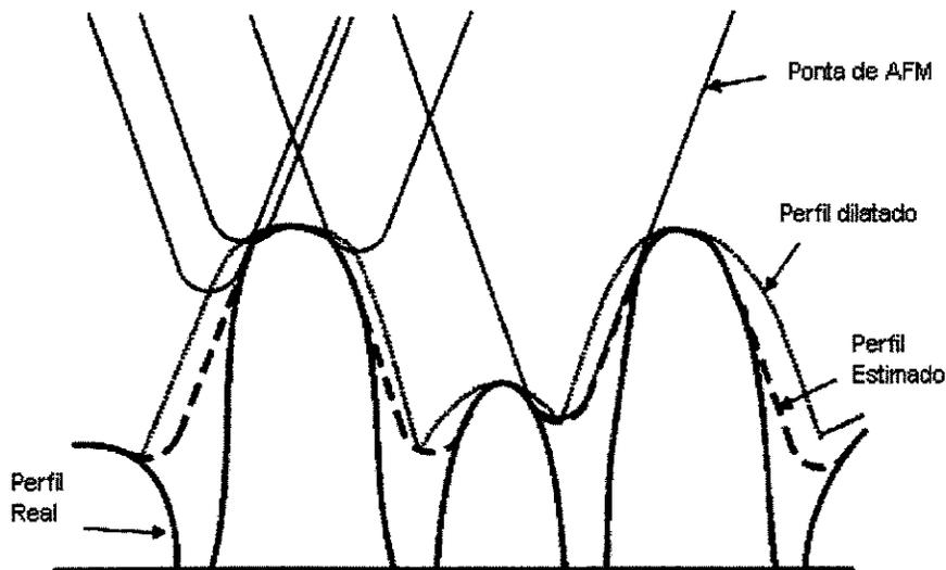
Figura 6.28 – Influência do formato da ponta de AFM no perfil real de uma superfície [KLAPETEK, 2003].
