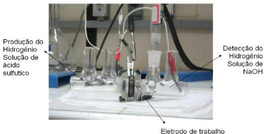
Figura 3.9 – Montagem da Célula eletroquímica.
