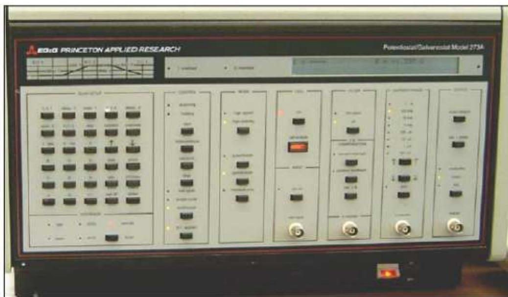
Figura 3.8 – Potenciostato/ Galvanostato-273A.
