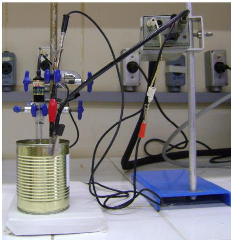
**Figura 13-** Foto da célula eletroquímica utilizada na obtenção dos dados de impedância nas embalagens.
