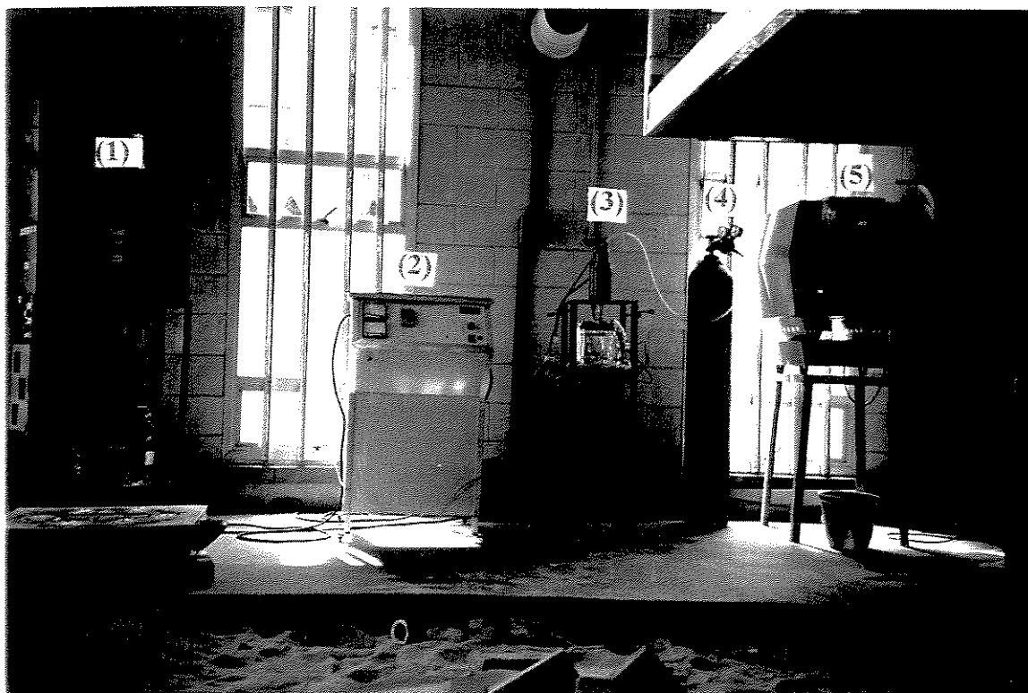
Figura 3.8 - Equipamento de Compofundição completo. (1) indicador de temperatura para termopar no banho de metal; (2) controladores de velocidade do motor de agitação e de temperatura do forno; (3) câmara de reofundição; (4) cilindro de argônio para proteção da atmosfera dentro do forno; (5) forno para aquecimento dos pós.
