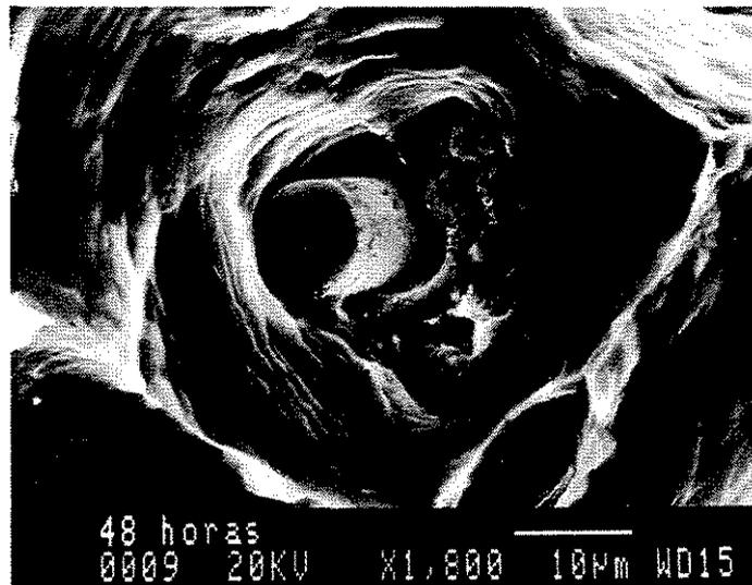
Figura 4.75 – Superfície de fratura do compósito tratado por 48 horas mostrando 4 fibras no interior de um mesmo alvéolo
