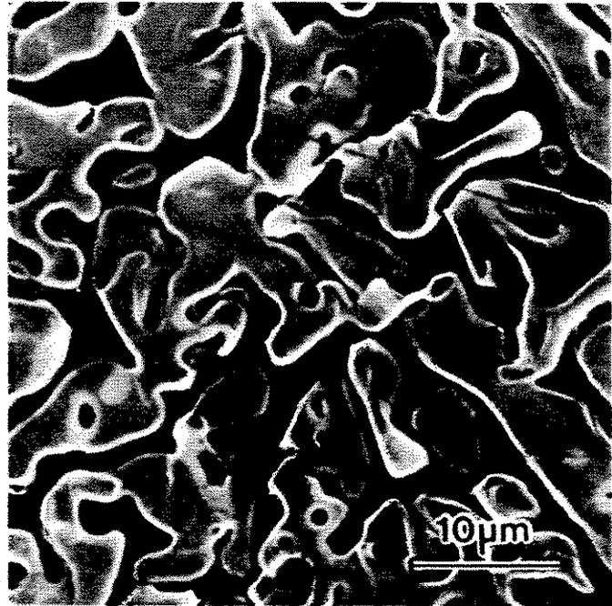
Figura 2.6 - Imagem obtida por MEV mostrando as duas fases entrelaçadas obtidas no compósito C<sup>4</sup>. A fase escura representa o alumínio e a fase clara a alumina. Breslin (1995)
