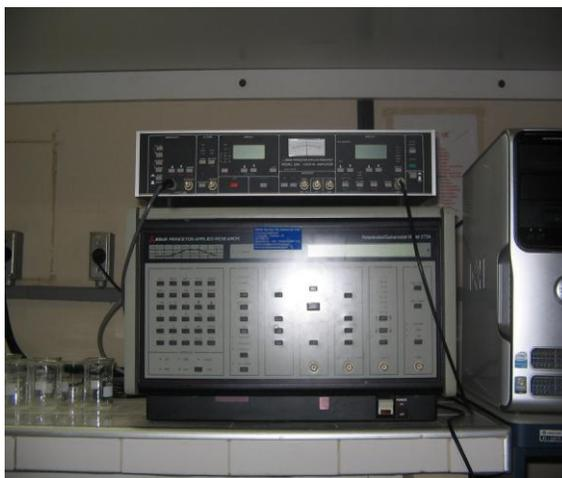
Figura 3.4: Foto do Potenciostato/Galvanostato-273A.
