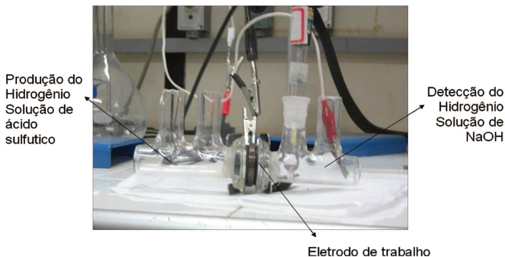
Figura 3.5: Montagem da célula eletroquímica.
