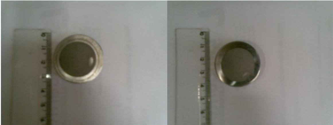
Figura 3.1 Amostras do Aço AISI 4340 (aço 1 esquerda e aço 2 direita)
