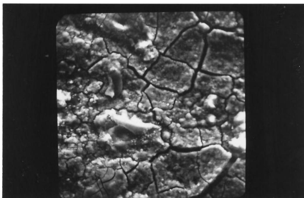
**Figura 20 ( ampliação 935X ) Detalhe do interior do ponto de corrosão.**
