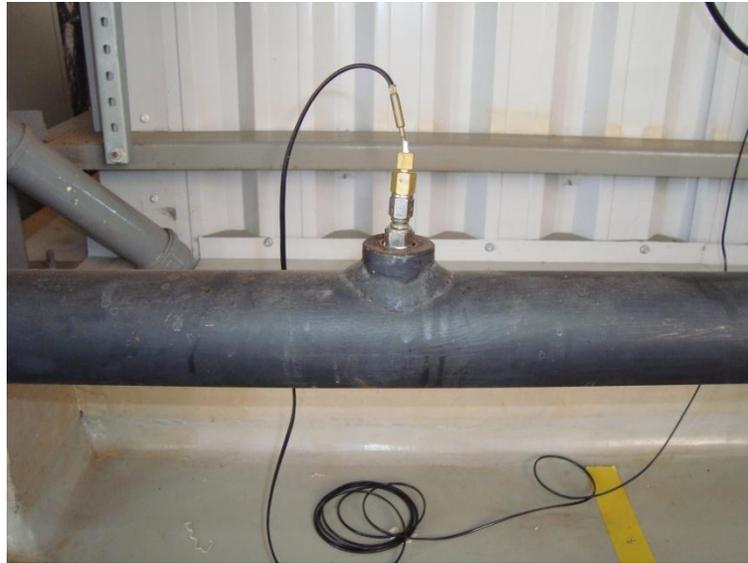
Fig. 3.10 Termopar para medição da temperatura do fluido.
