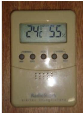
Fig. A.3 Termohigrômetro.
