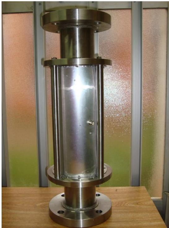
Fig. 2.3 Uma sonda capacitiva.
