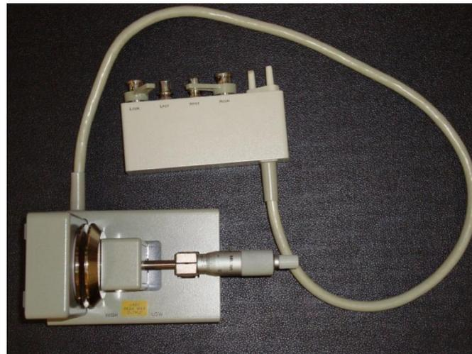
Fig. B.2 Dispositivo Testador de Dieletrico.
