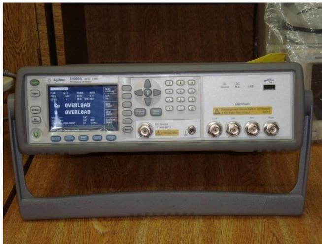
Fig. 3.5 Medidor LCR.
