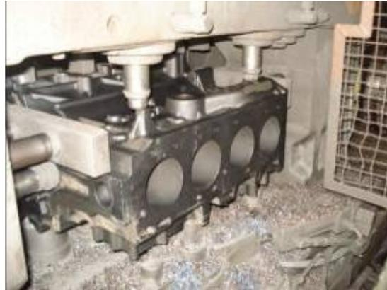
Figura 3.3: Dispositivo de fixação da máquina com o bloco de motor fixado e a vista da face do cabeçote.
