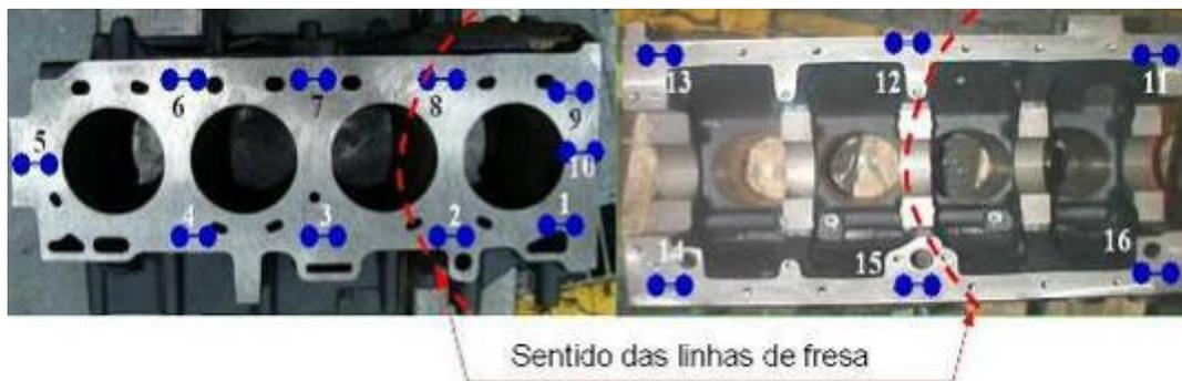
Figura 4.11: Definição de posicionamento para deslocamento do sensor do rugosímetro.
