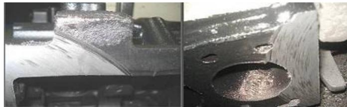
Figura 3.9: Sobremetal: carter à esquerda e cabeçote à direita.
