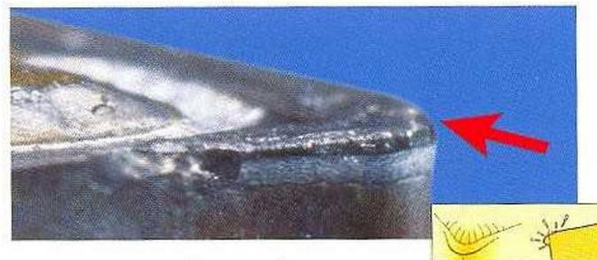
Figura 2.17: Desgaste por deformação plástica, [(Sandvik, 2002) apud (Ferrer, 2006)].
