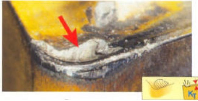
Figura 2.15: Desgaste por craterização, [(Sandvik, 2002) apud (Ferrer, 2006)].
