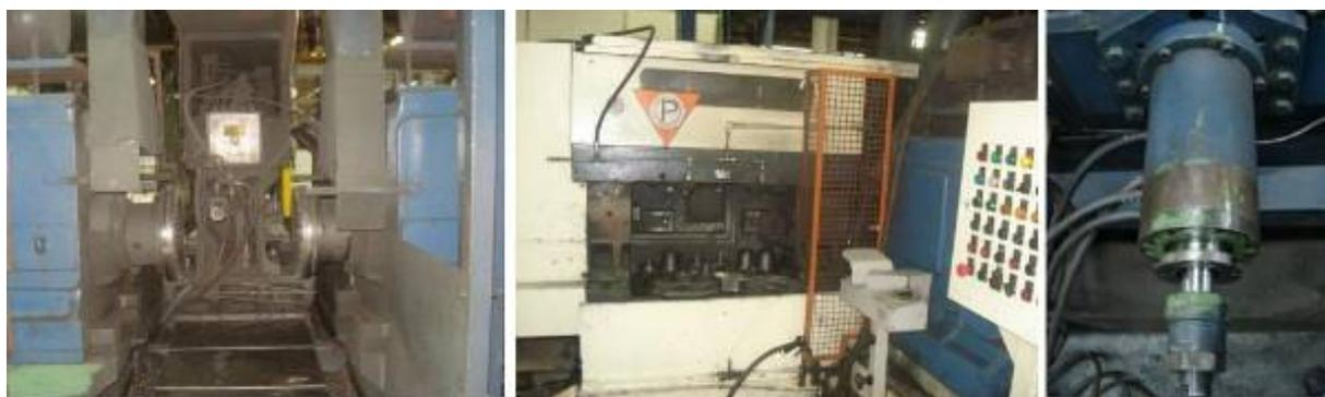
Figura 3.2: Fresadora Duplex em três vistas: o conjunto de duas fresas; o conjunto do dispositivo com a mesa e o cilindro de ajuste para batente de posicionamento intermediário.
