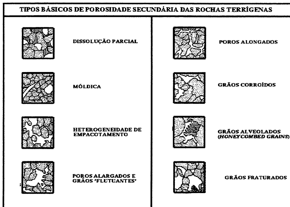
Figura 2.1b - Classificação dos tipos de porosidade secundária para rochas terrígenas. (Schmidt, McDonald & Platt, 1977, apud Monteiro, 1995).
