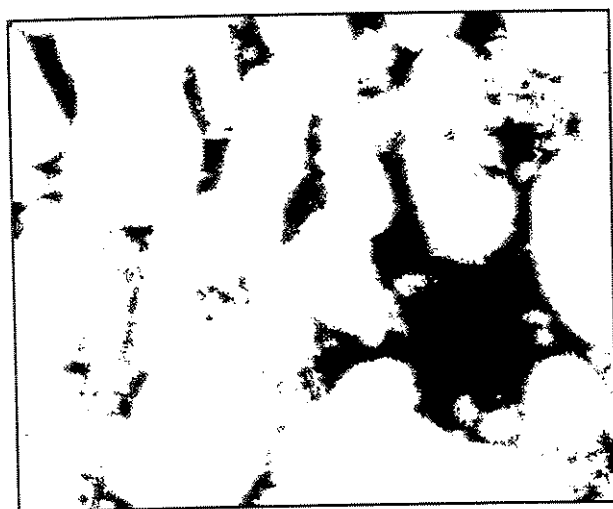
(b) Imagem i16b: \text{PHI} = 15,52 \% ; I_s = 129,72 \mu\text{m} ; K = 524,20 \text{ mD} ; resolução 3,125 \mu\text{m/pixel} .
