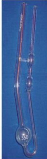
Figura 4.1 – Viscosímetro de Ostwald semelhante ao utilizado nas determinações de viscosidade.
