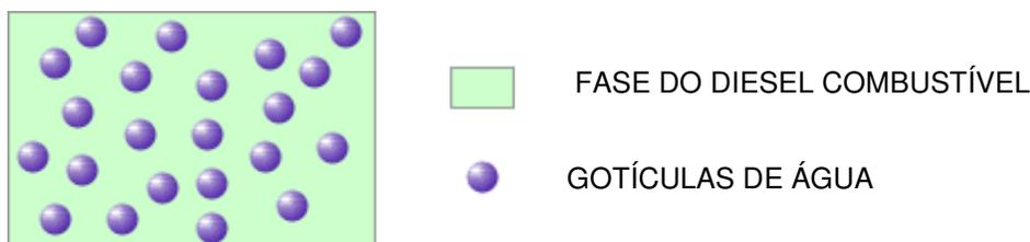
Figura 1.3 – Emulsão da água dispersa no Diesel. Traduzida de *Dieselnet* (2007).
