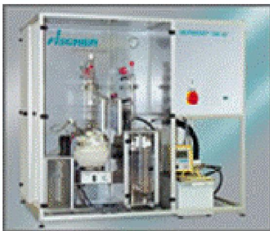
Figura 4.4 – Equipamento para determinação de porcentagem de água em massa pelo método de titulação de Karl Fischer, nas emulsões combustíveis.
