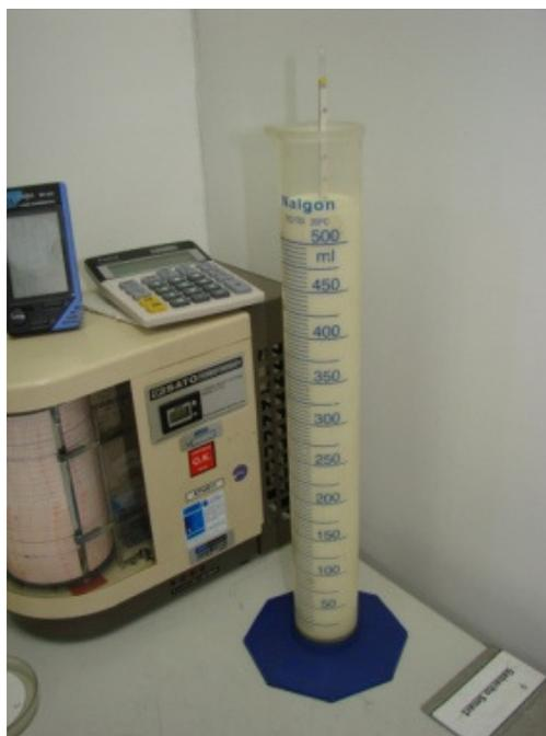
Figura 4.3 – Densímetro por imersão utilizado para determinação das densidades das emulsões combustíveis.
