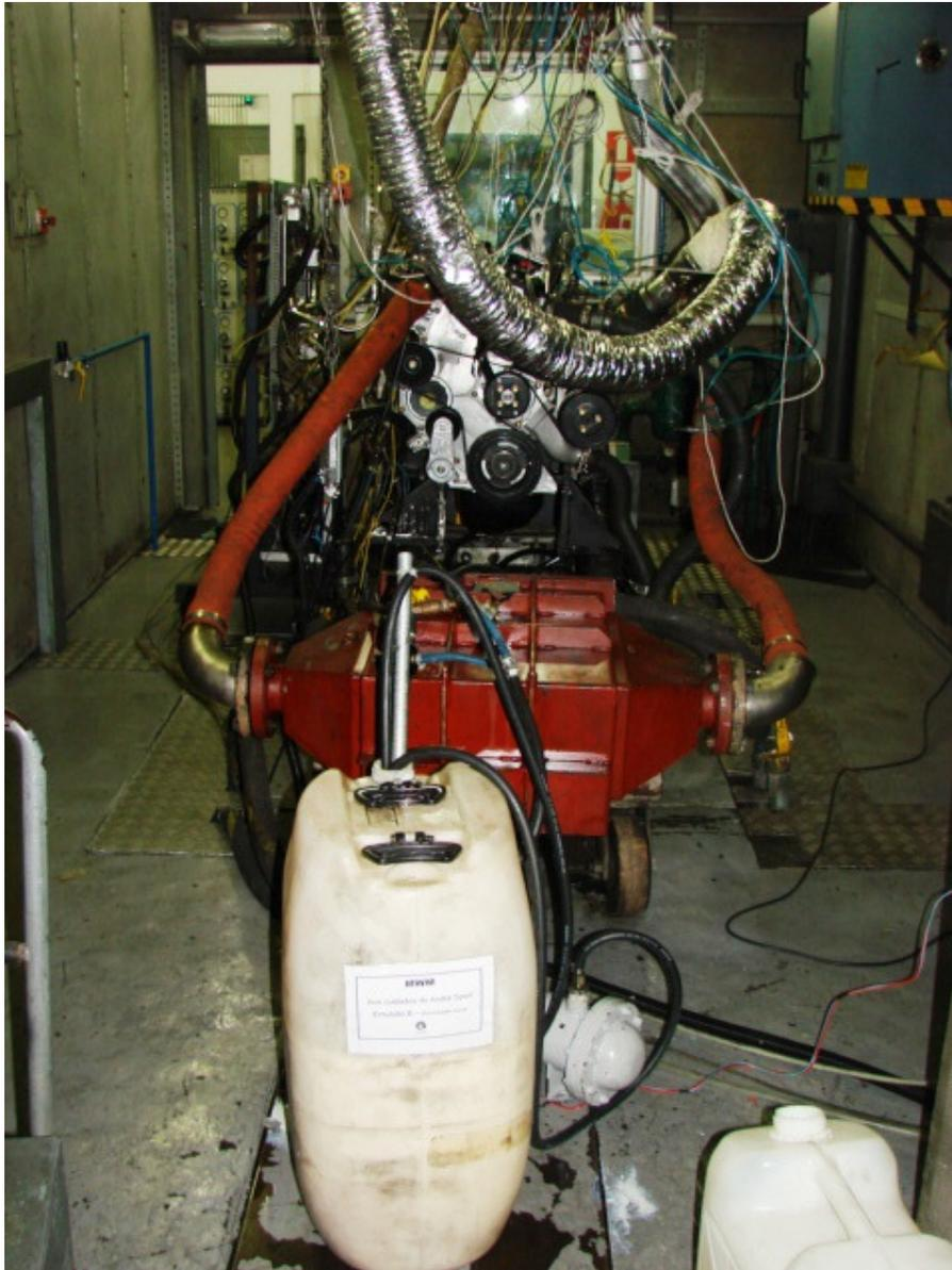
Figura 4.12 – Motor em ensaio com emulsões.
