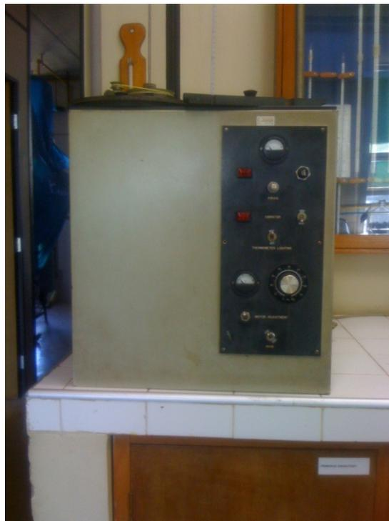
Figura 4.5 – Bomba calorimétrica utilizada para medição do poder calorífico superior dos combustíveis ensaiados.
