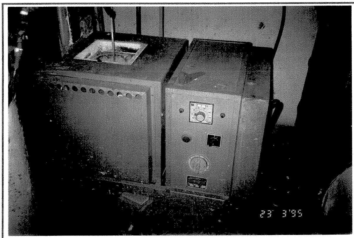
FIGURA 5.5 - Forno de resistência elétrica utilizado nos experimentos para refundir a liga.
