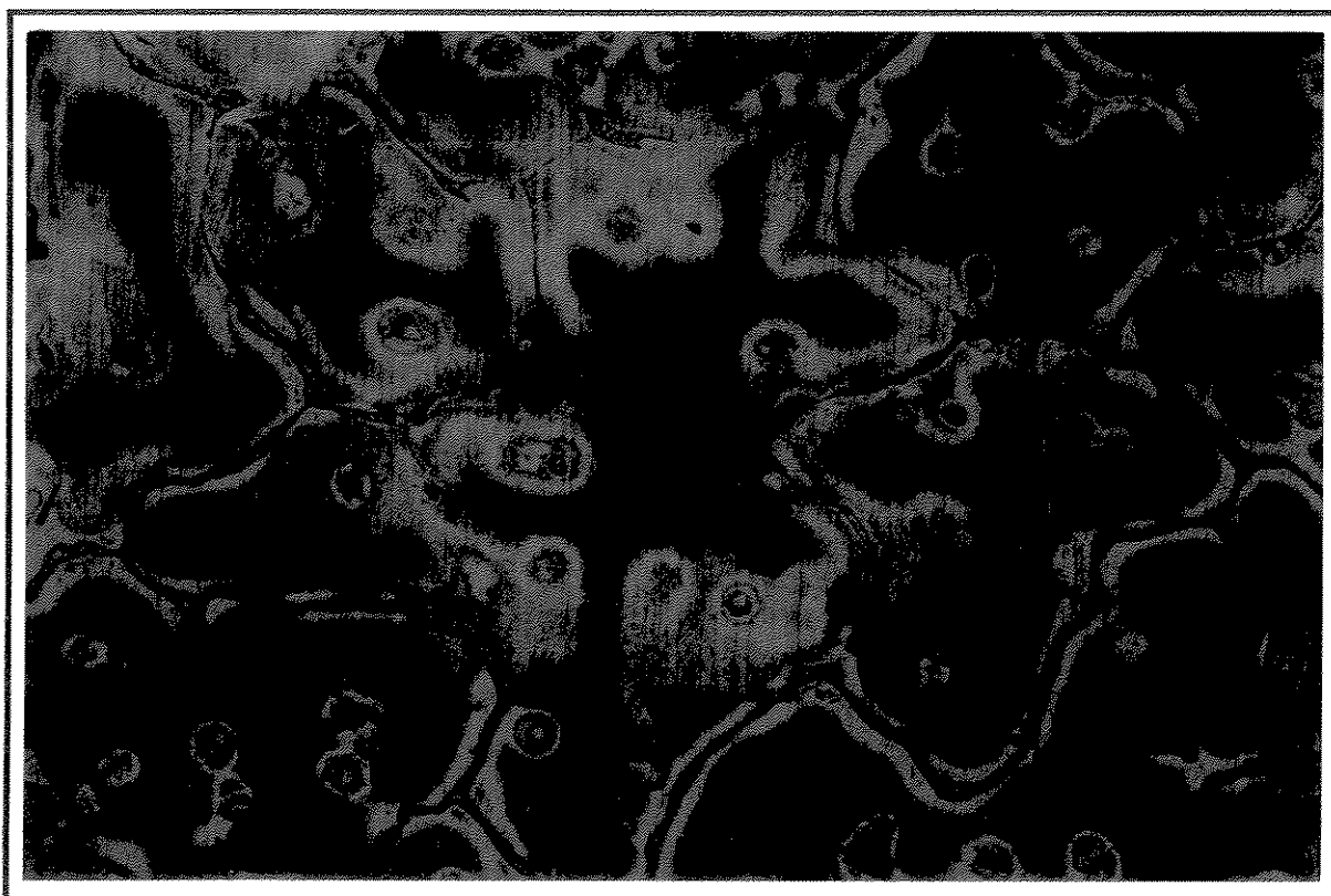
FIGURA 7.30 - Micrografia da liga Al-4,5%Cu corte transversal distante 14 mm da coquilha, com taxa de resfriamento de 5°C/s. Ataque 'especial'. Aumento 500x.
