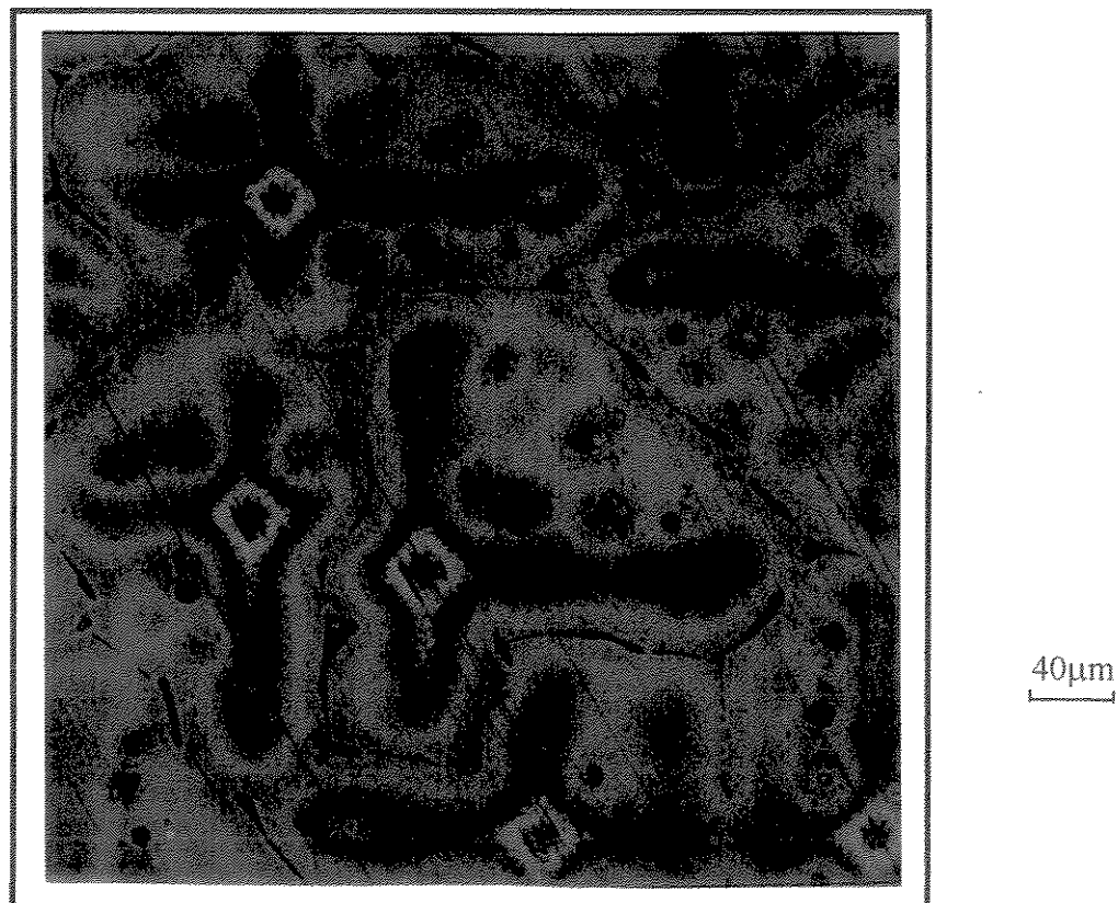
FIGURA 6.24 - Micrografia Al-4,5%Cu solidificação direcional, corte transversal. Ataque 'especial'. Aumento 250x.
