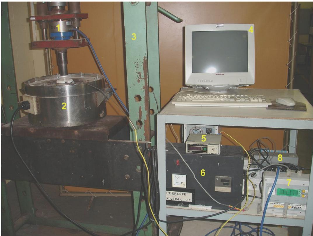
Figura 3.7: Equipamentos utilizados no processo de fabricação das esponjas metálicas. (1) célula de carga; (2) forno resistivo; (3) prensa hidráulica; (4) microcomputador; (5) indicador de temperatura; (6) controlador de aquecimento do forno; (7) indicador de pesagem; (8) placa de aquisição de dados.
