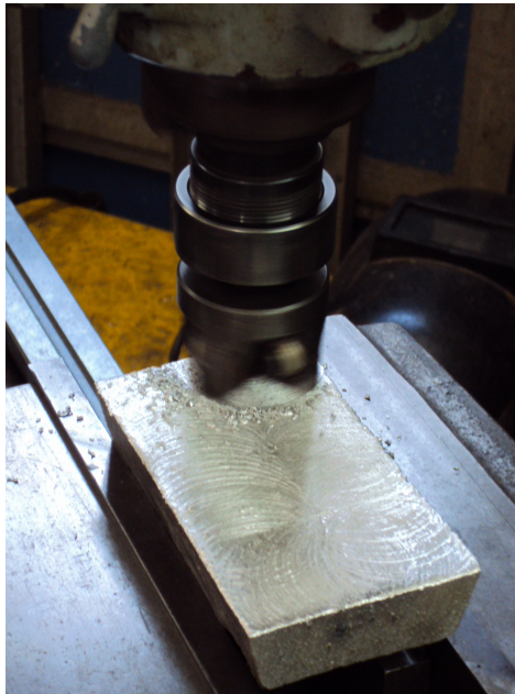
Figura 3.7: Operação de fresamento adotada para fabricação de cavacos da liga AA356.
