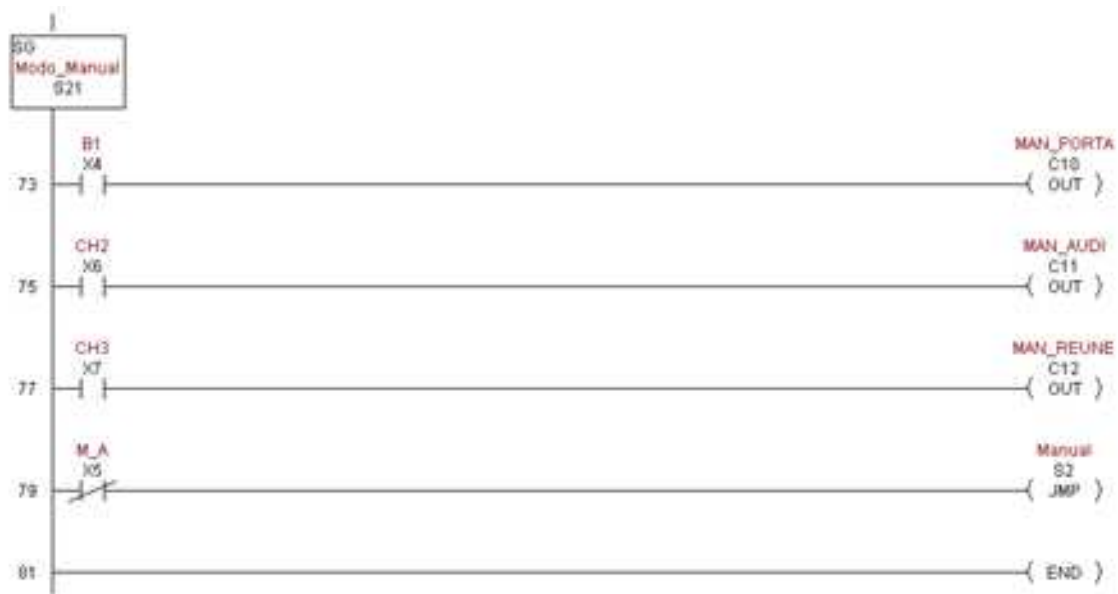
Figura 4.21 GRAFCET funcional Detalhamento de etapas – modo Manual.
