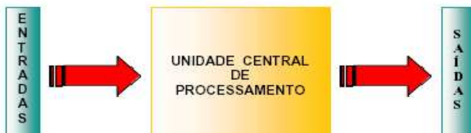
Figura 3.6 Esquema de funcionamento de um CLP.
