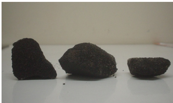
Figura 29. Pedacos de coque formados durante Experimento 1
