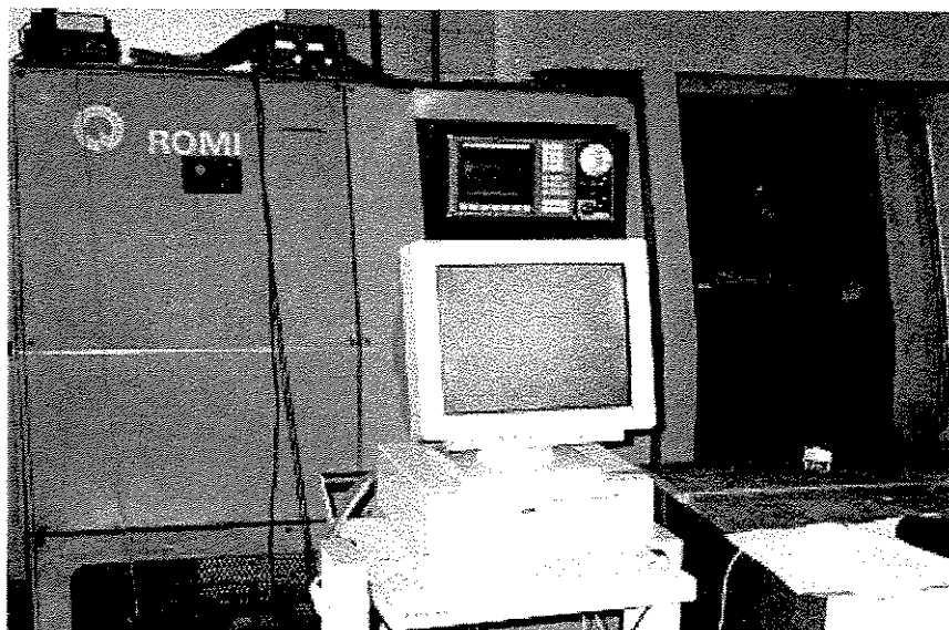
Figura 6.5 - Torno CNC utilizado nos ensaios.
