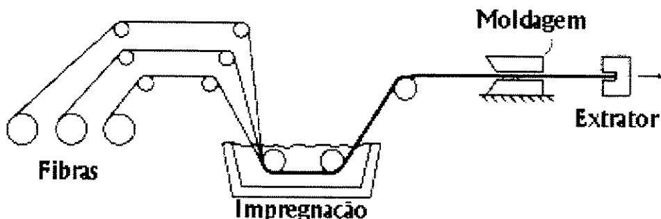
Figura 2.12 - Esquema do processo de pultrusão.
