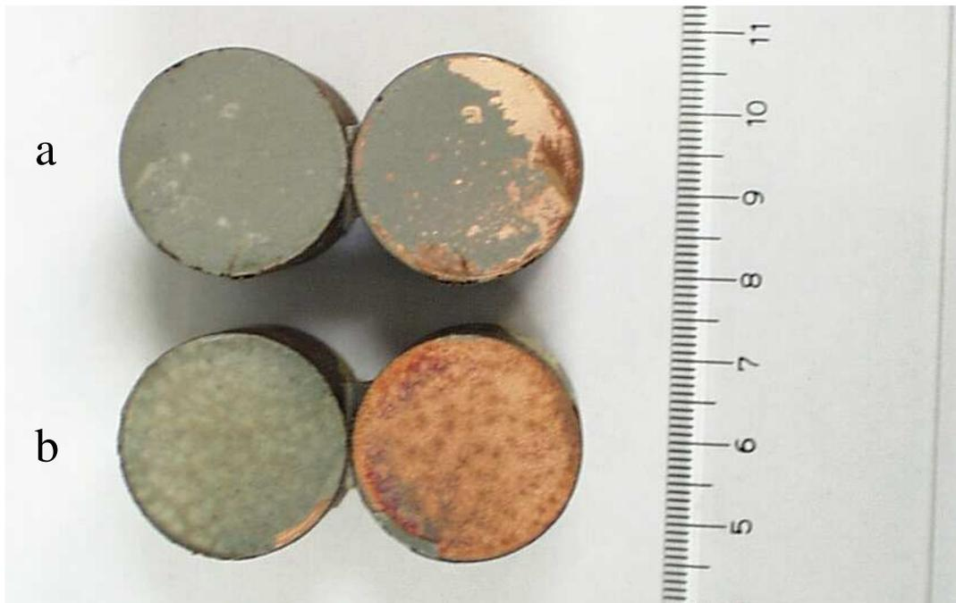
Figura 4.20 Amostras do ensaio de tração a. com tratamento térmico b. sem
