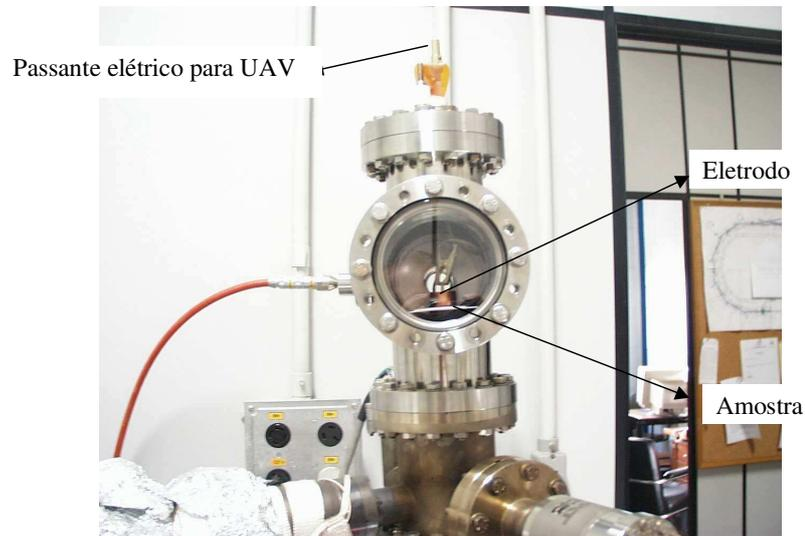
Figura 3.3 Montagem do sistema de teste de ruptura em alto vácuo.
