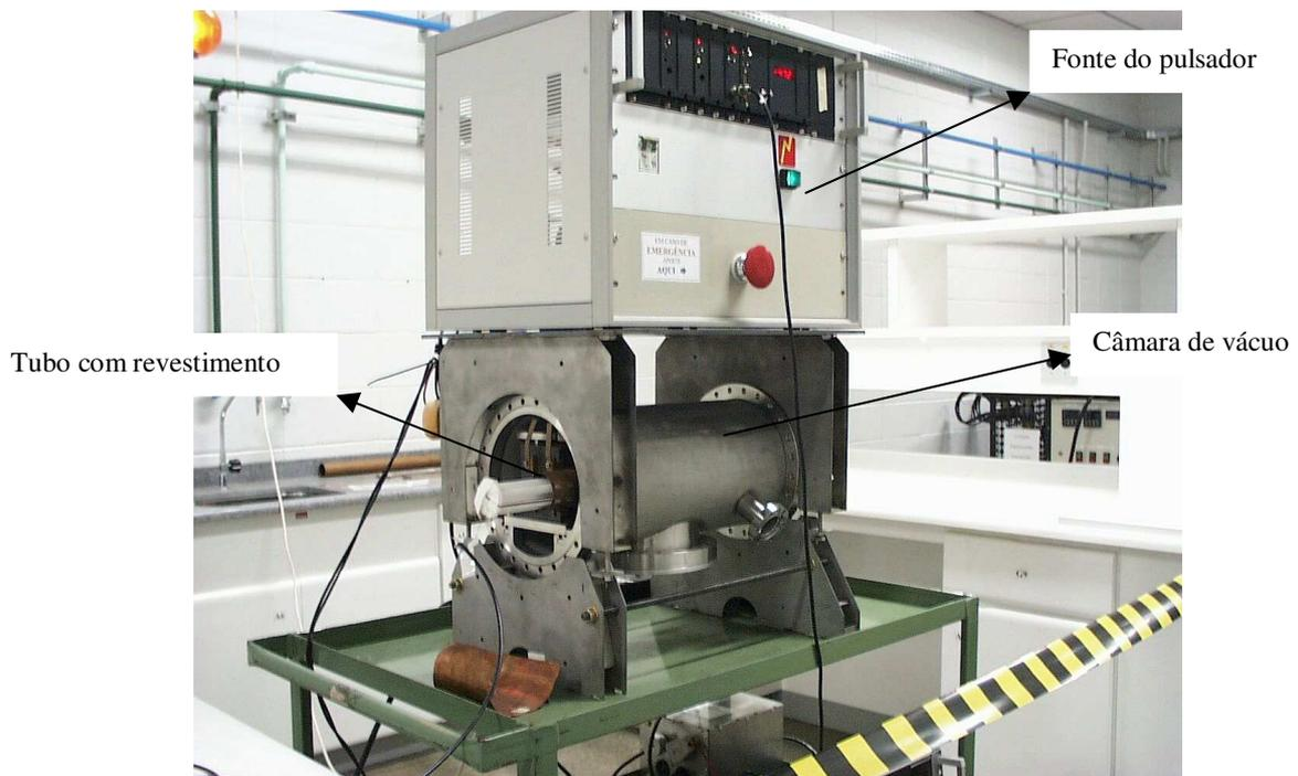
Figura 3.4 Montagem do *septum* no ar, para teste mecânico do protótipo.
