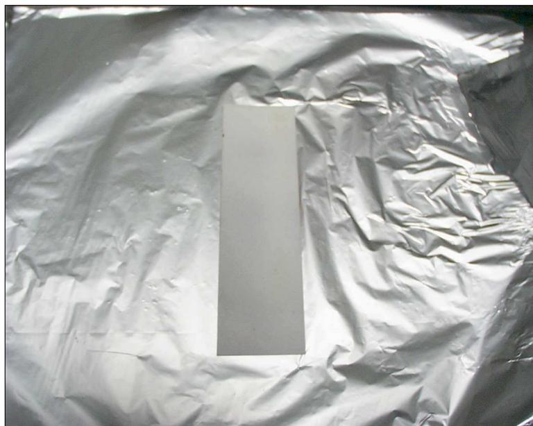
Figura 4.1 Amostra n.1 plana com deposição nas duas faces.
