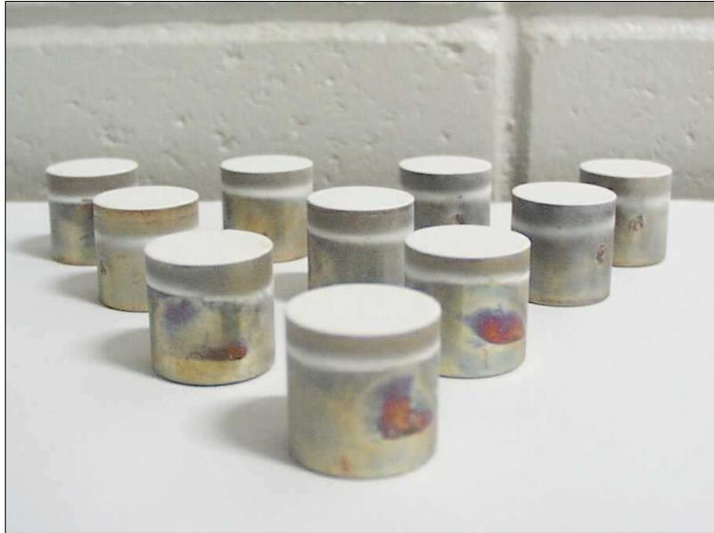
Figura 4.2 Corpos de prova do ensaio de adesão.
