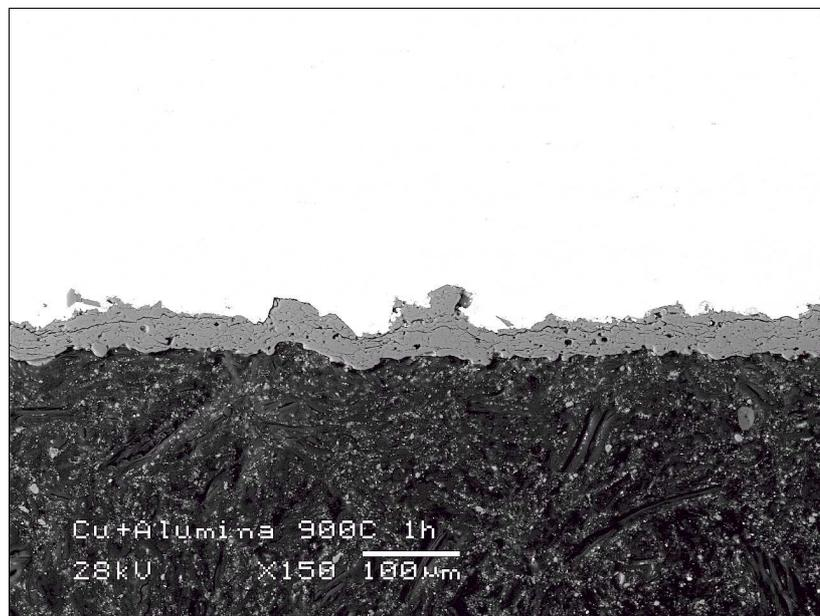
Figura 4.9 MEV do perfil transversal da amostra 3 com tratamento térmico.
