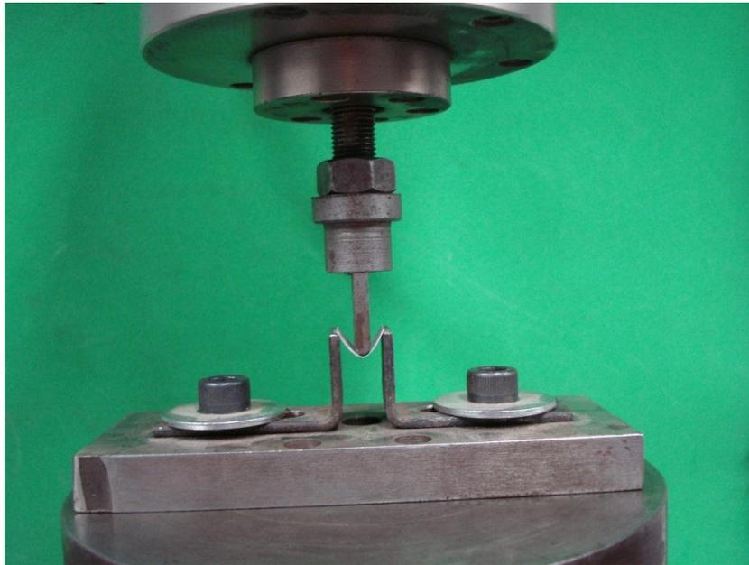
Figura 4.13: Fotografia do dispositivo para ensaio de dobramento.
