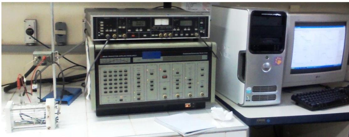
Figura 3.4: Sistema de espectroscopia de impedância eletroquímica.
