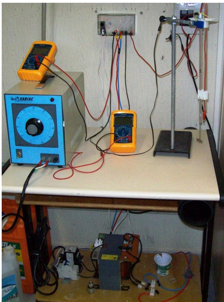
Figura 3.1: Fotografia do equipamento experimental para o processamento PEO.
