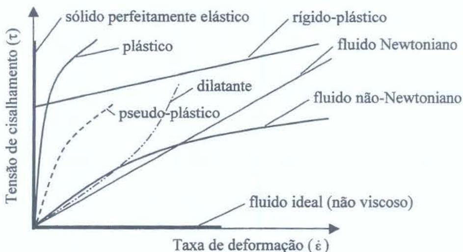
Figuras 3.2 – Representação esquemática de determinadas curvas tensão-deformação de alguns materiais sólidos e líquidos.
