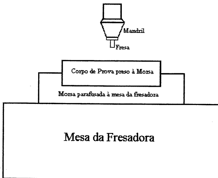
FIGURA 4.6 – Fixação do Corpo de Prova à Mesa do Centro de Usinagem feita na 2ª Bateria de Ensaaios
