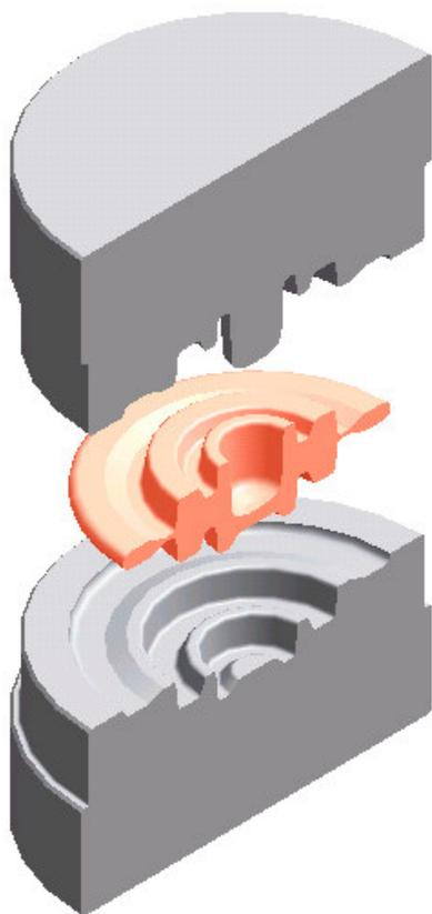
Figura 2. 2 - Ferramental para forjamento convencional.
