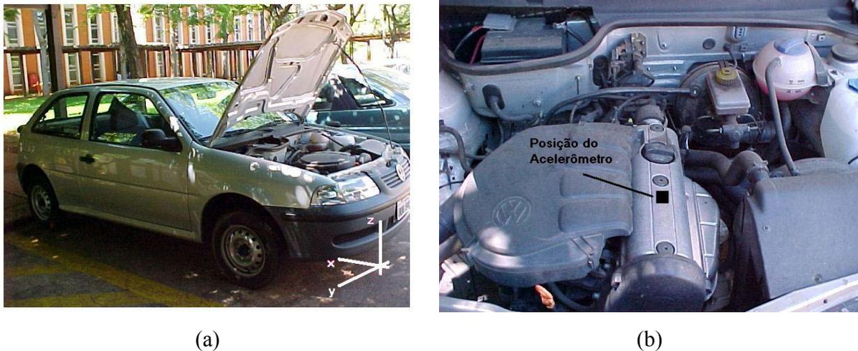
Figura 6.30: Carro utilizado no experimento com indicação dos eixos x (longitudinal), y (transversal) e z (vertical) e posição do acelerômetro triaxial fixado no cabeçote motor.
