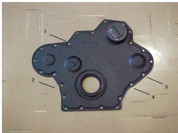
Figura 6.19: Tampa do motor de ônibus analisada e localização dos sensores.
