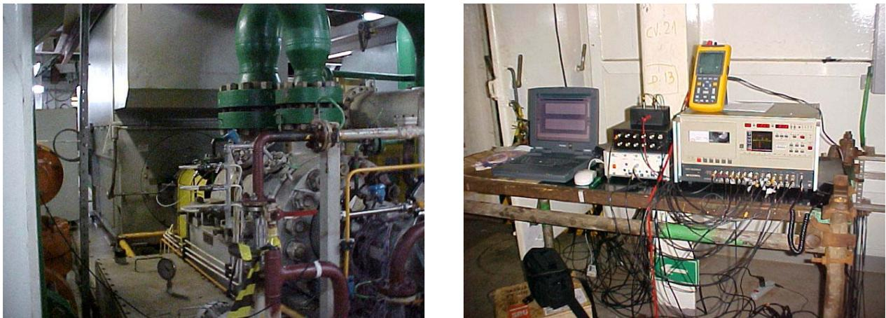
Figura 6.24: Bomba hidráulica analisada e vista geral da instrumentação utilizada nas medições.
