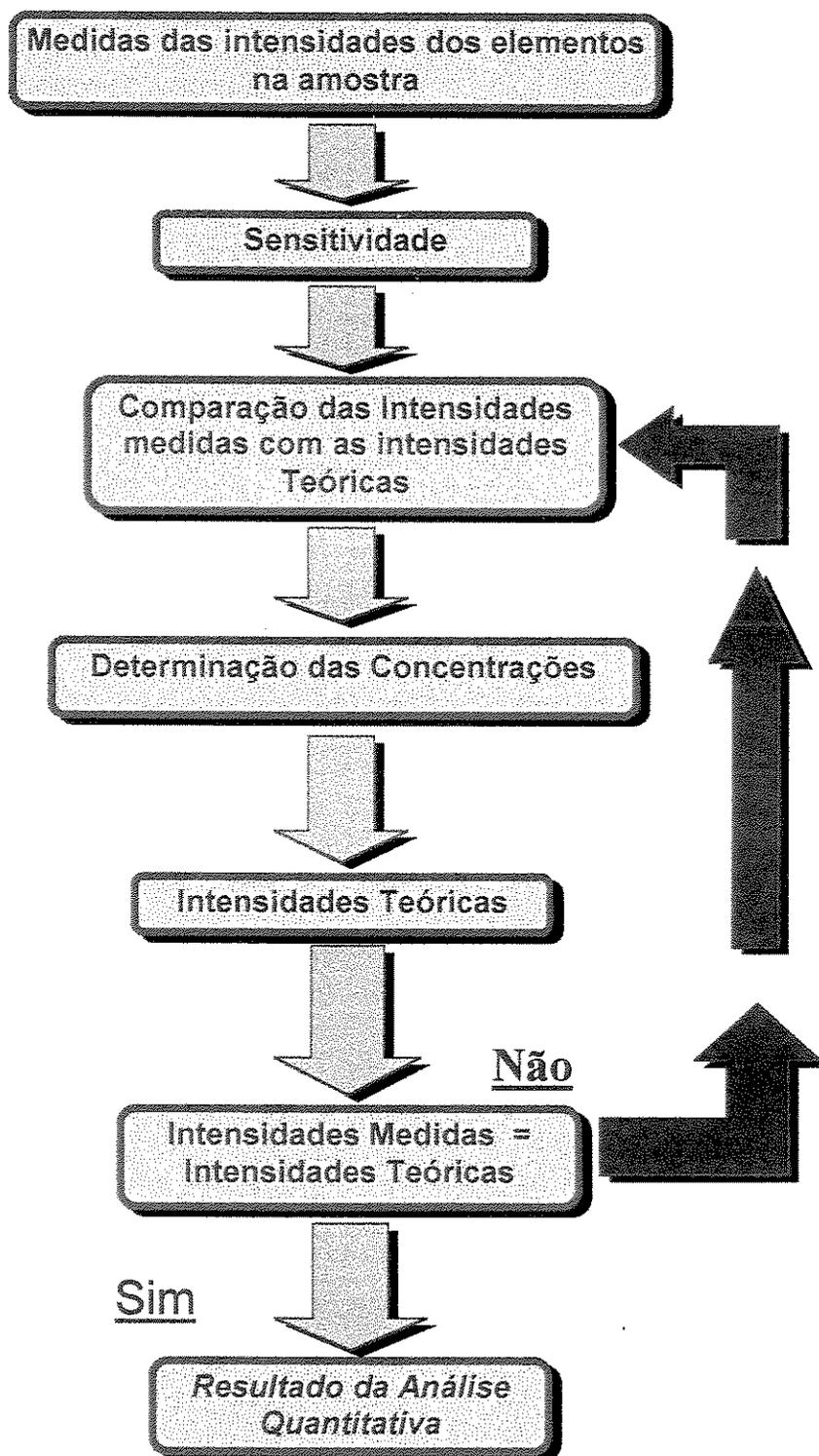
Figura 2. Fluxograma da análise quantitativa pelo método dos Parâmetros Fundamentais.
