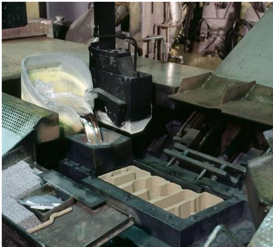
Figura 2.24 - Vazamento de uma liga de alumínio em molde de cabeçote de motor pelo processo de fundição por gravidade [AAM, 2003].
