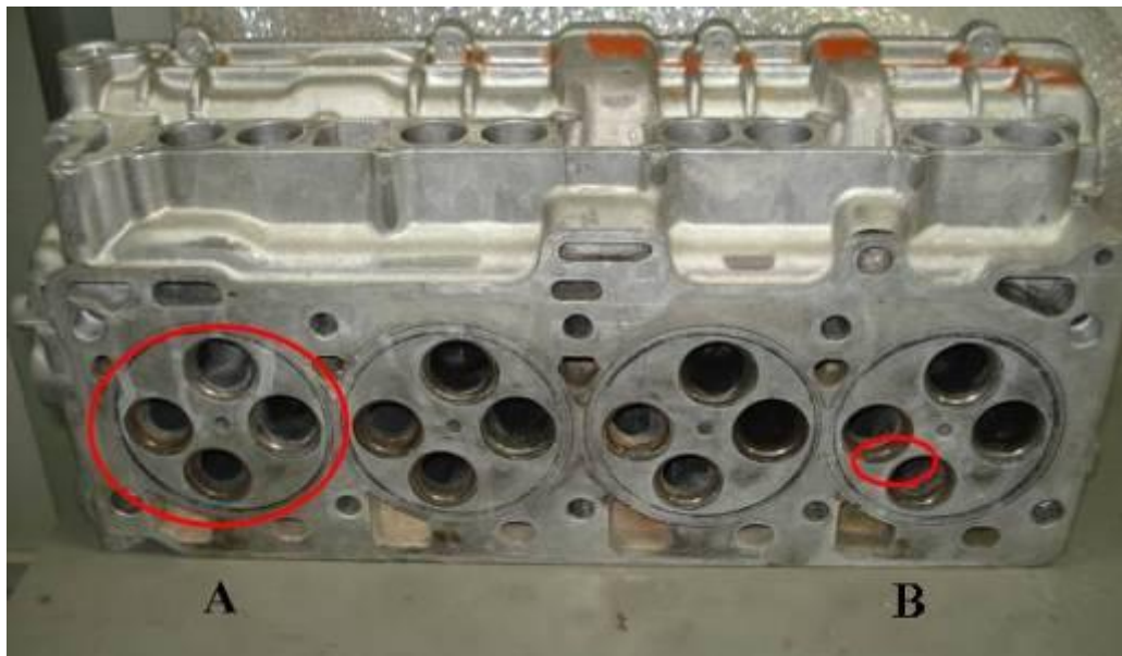
Figura 2.15 - Foto ilustrativa da região do cabeçote que é submetida à fadiga em alto ciclo (A= face de fogo) e baixo ciclo (B= ponte entre as válvulas de escape/ válvulas de admissão).
