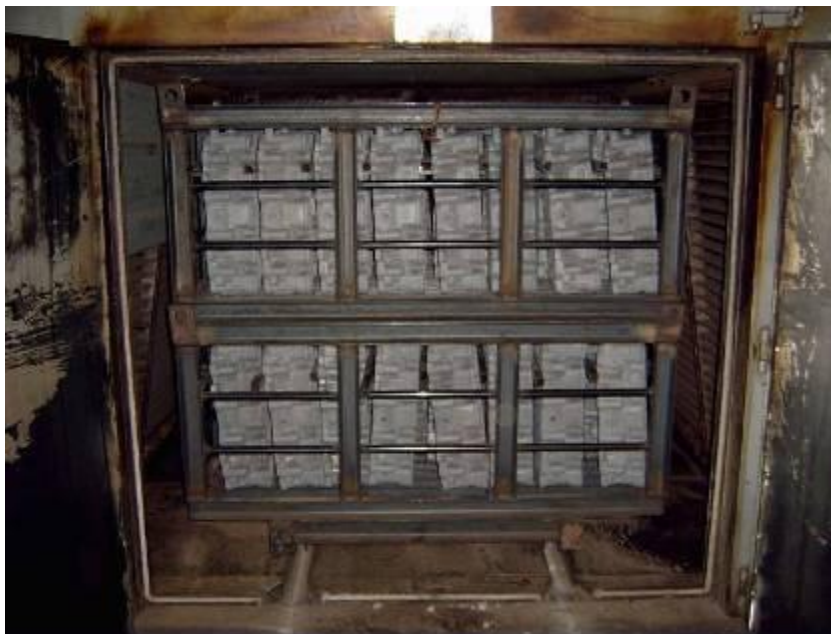
Figura 2.6 - Vista frontal de uma carga de cabeçotes posicionada em 2 níveis num forno de precipitação.
