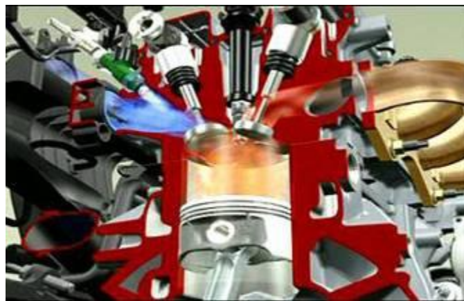
Figura 2.14 - Seção transversal de um motor ilustrando a face de fogo, na face inferior do cabeçote, que está sujeita à fadiga em alto ciclo [PAVLAK, 2008].
