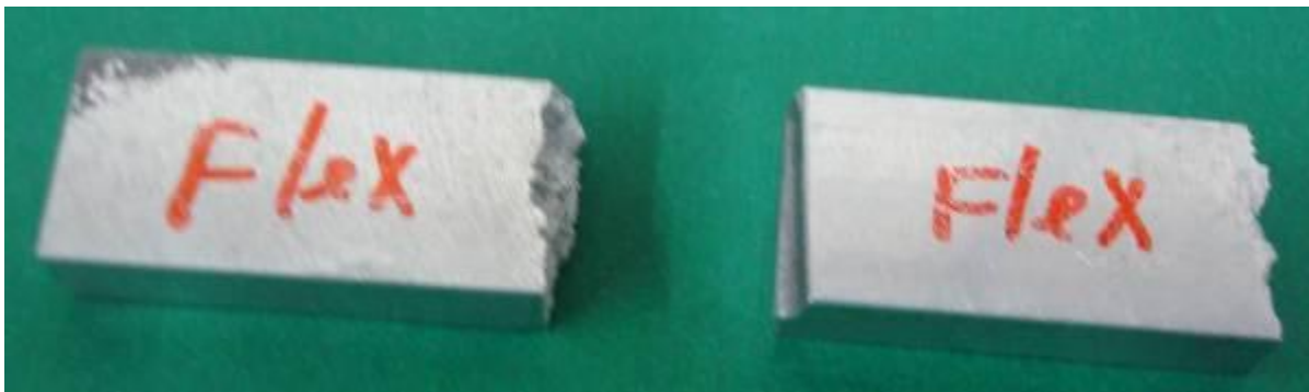
Figura 4.2 - aspecto dos corpos-de-prova que romperam no ensaio de fadiga
