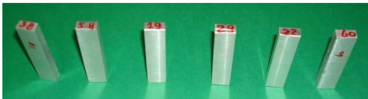
Figura 3.14 - Aspecto dos corpos-de-prova usinados para os ensaios de fadiga.
