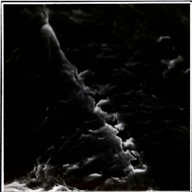
Figura 5.37. Coalescimento de vazios nucleados em contorno de grão de amostra deformada a 7% e envelhecida. 4500X(MKV)
