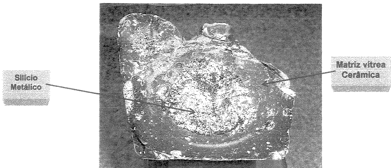
Figura 39. Bloco de escória refundido por plasma, tendo ao centro o silício metálico envolto na matriz vitro-cerâmica.
